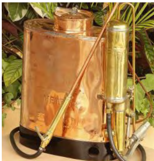
Figura 1.1.4.2. Equipo pulverizador manual (mochila) de 1887.
