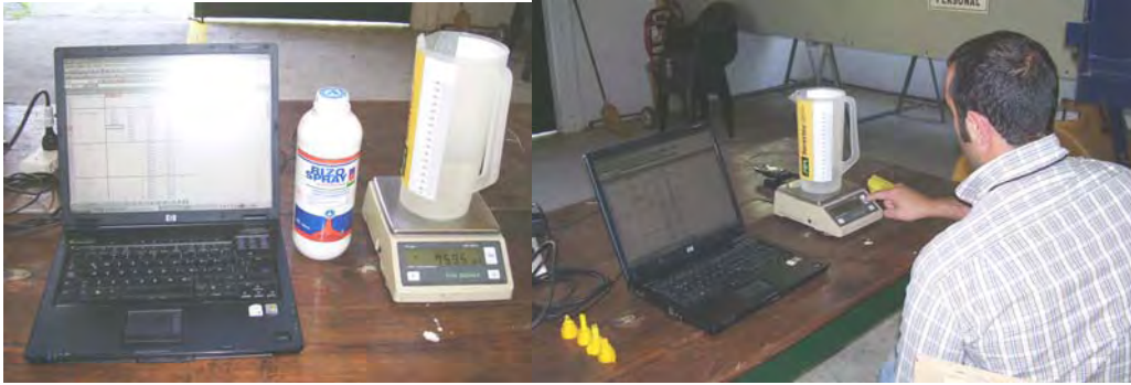
Figura 2.4. Determinaciones gravimétricas del volumen recolectado en el banco de distribución.
