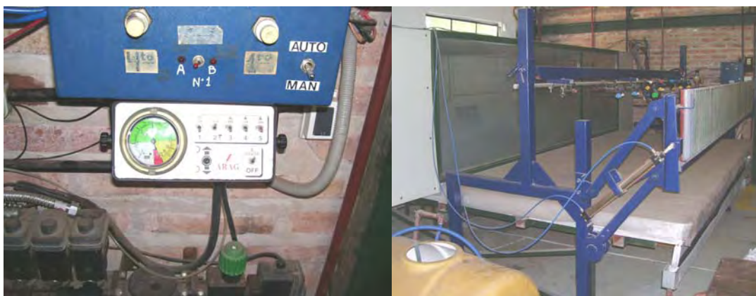
Figura 2.1. Vista parcial del comando de pulverización y probetas del banco de distribución.
