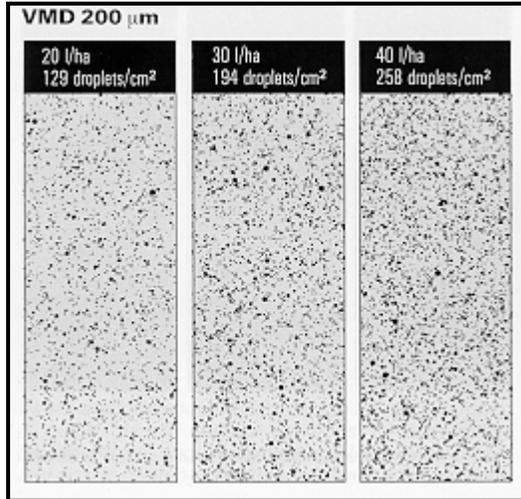
FIGURA 1 – Relación entre Volumen de Aplicación y Densidad de Gotas en pulverización con Diámetro Mediano Volumétrico (DMV) de 200 micrones (200 µm) (\*):
