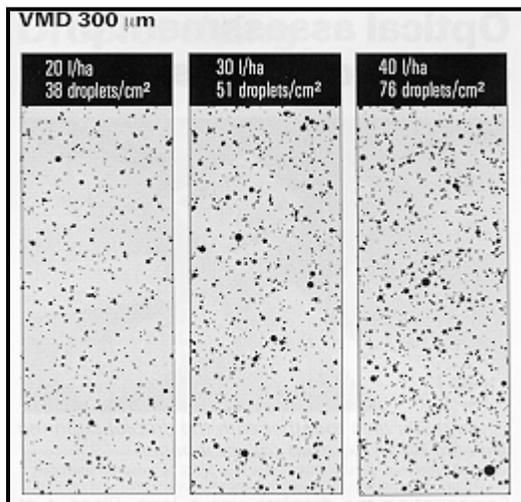
FIGURA 2 – Relación entre Volumen de Aplicación y Densidad de Gotas en pulverización con Diámetro Volumétrico Mediano (VMD) de 300 micrones (300 µm) (\*):
