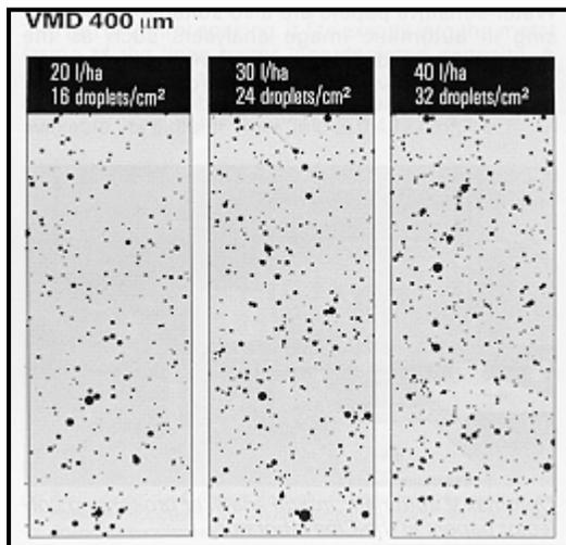
FIGURA 3 – Relación entre Volumen de Aplicación y Densidad de Gotas en pulverización con Diámetro Volumétrico Mediano (DVM) de 400 micrones (400 µm) (\*):
