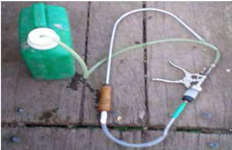
Fotografía 3. Dispositivo para dosificar el marcador externo, LIPE®.
