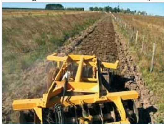
Consolidación de cortafuego con rastra de disco. Foto Alejandro G. Di Giacomo.
