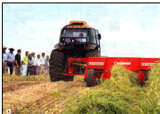
2.- Cortadora de pasto. La elaboración de un buen heno desde una pastura de calidad comienza por la elección de una cortadora que no desgarre las plantas.
