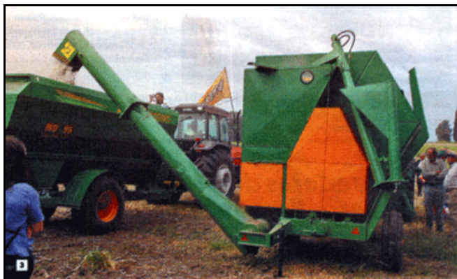
3.- Desmenzadora de rollos. Permite aprovechar mejor el rollo al evitar el pisoteo, o bien incorporarlo a la ración de alimento. 4.- Embutidora de grano húmedo quebrado. De gran utilidad para elaborar el silo de grano húmedo y racionar a la hacienda.
