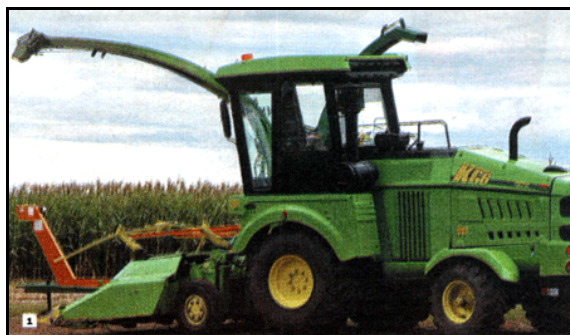
1.- Picadora de forraje con cabezal rotativo; permite circular sin seguir las hileras del maíz.
