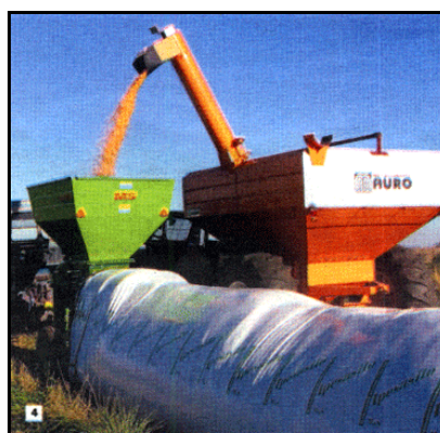
3.- Desmenzadora de rollos. Permite aprovechar mejor el rollo al evitar el pisoteo, o bien incorporarlo a la ración de alimento. 4.- Embutidora de grano húmedo quebrado. De gran utilidad para elaborar el silo de grano húmedo y racionar a la hacienda.
