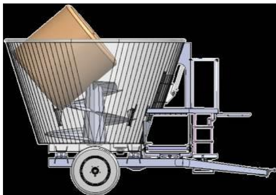
Figura 4: forma en que se colocó el rollo para un eficiente uso de la potencia.
