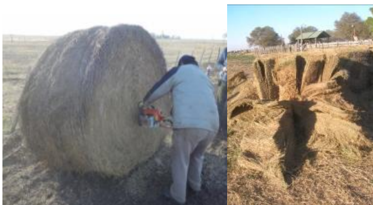
Figura 2. Izq: Corte de un rollo con motosierra. Der: rollo cortado en porciones
