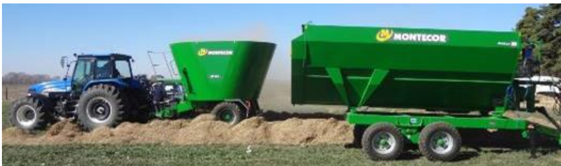
Mixer desmenuzadores de porciones de rollos o megafardos y mezcladores de fibra muy larga: con sinfín trozador, reductor epicicloide y caja de alta y baja.
