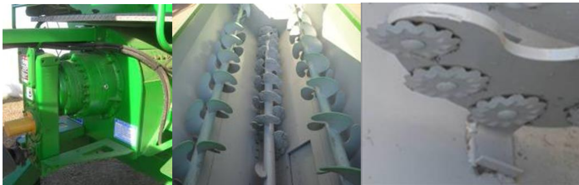
Figura 1 A: detalle del reductor epicicloide. B: Sistema de tres sinfines a paletas de avance desencontrados Sinfín inferior con cuchillas “tipo margaritas” y contra-cuchillas incorporadas a la batea. Detalle cuchilla tipo margarita y contra-cuchilla.
