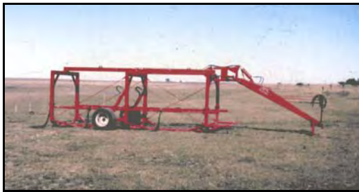
a)-Carga rollos (Mainero); carga y transporta 4 rollos en fila; tiene 2 hidráulicos, uno lateral y otro para subir y bajar b)-Transportador de un rollo; San Pablo, Tilisarao, Crea Valle del Conlara.
