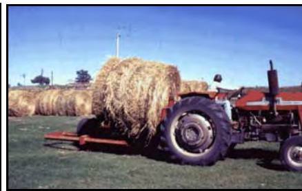
a)-Carga rollos (Mainero); carga y transporta 4 rollos en fila; tiene 2 hidráulicos, uno lateral y otro para subir y bajar b)-Transportador de un rollo; San Pablo, Tilisarao, Crea Valle del Conlara.
