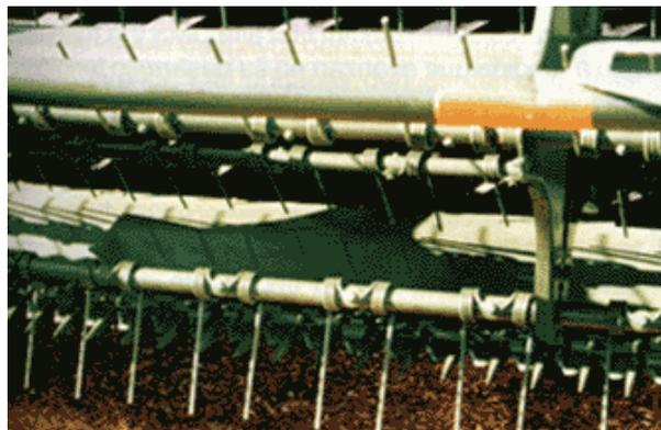
Figura 110: Segadora con cuchillas triangulares
