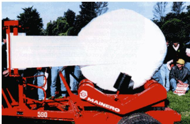
Figura 116.- Máquina empaquetadora para confección de "silopack"
