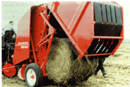
Figura 115: Enrolladora de forraje para rollo de núcleo compacto
