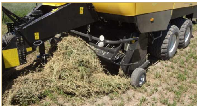
Figura 14: bollos que se generan al rastrillar con mayor humedad y que dificultan la alimentación de las máquinas.
