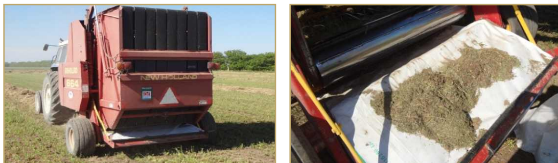
Figura 16: Medición de pérdidas en cámara de compactación en Rotoenfardadora New Holland 664.
