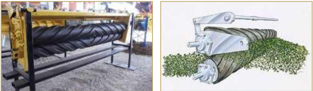
Figura 12: Esquema de trabajo de un sistema de acondicionado mediante rodillos.
