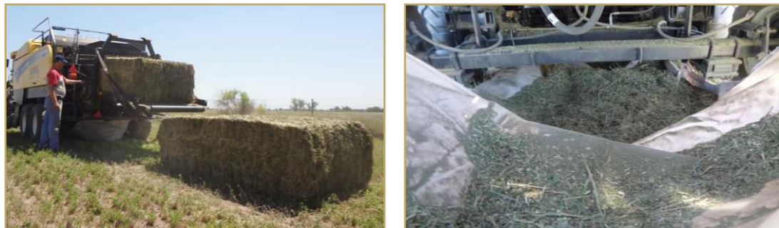
Figura 15: Medición de pérdidas en cámara de compactación en Megaenfardadora BB9070 con y sin CropCutter.
