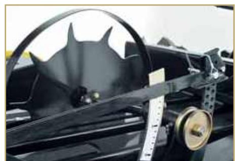
Figura 7: rueda dentada que mide los movimientos del megafardo dentro de la cámara (CNH, 2011)
