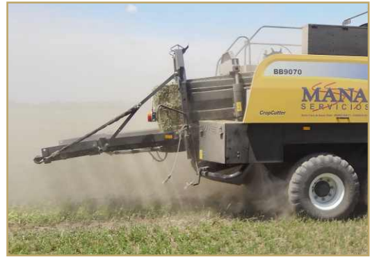
Figura 8: detalle de la rampa de descarga.
