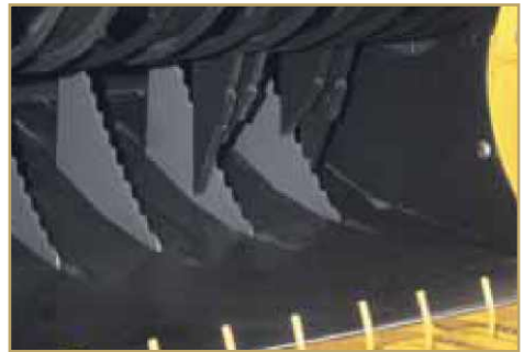
Figura 3: detalle de sistema CropCutter (CNH, 2011).
