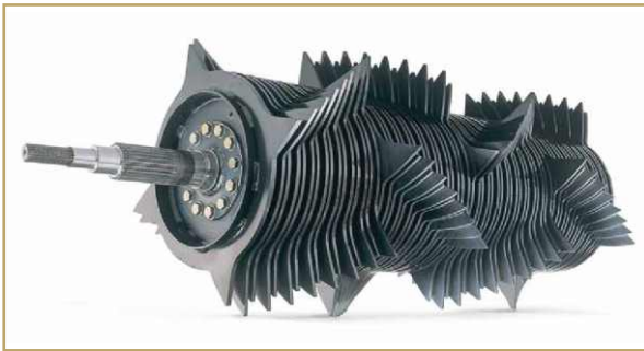
Figura 2: rotor alimentador en las versiones CropCutter (CNH, 2011).
