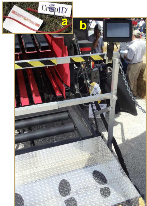
Figura 9: (a) Chip de radiofrecuencia ubicado en el hilo. (b) sensores de peso de fardo que están conectados a un GPS y permiten realizar mapas de productividad de la pastura a enfardar.
