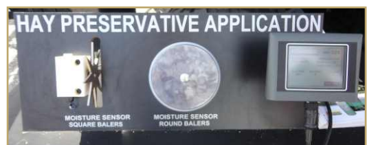
Figura 10: detalle del sensor de humedad.
