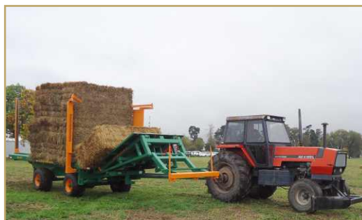
Figura 18: Carro recolector de Megafardos Agromec (capacidad de apilar 14 unidades).
