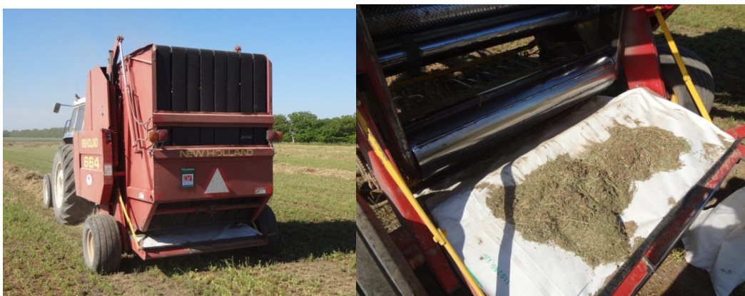
Figura 4: medición de pérdidas en cámara de compactación en rotoenfardadora New Holland 664.
