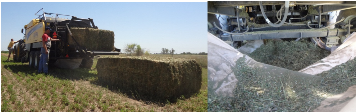
Figura 3: medición de pérdidas en cámara de compactación en megaenfardadora BB9070 con y sin CropCutter.
