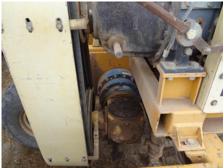
**Figura 10: reemplazo del reductor BREVINI original.**
