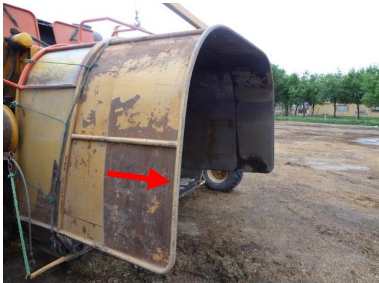
**Figura 8: prolongación del túnel en 0,7 m.**
