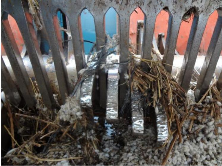
**Figura 11: mantenimiento en muy buen estado los dedos móviles del rotor transversal.**
