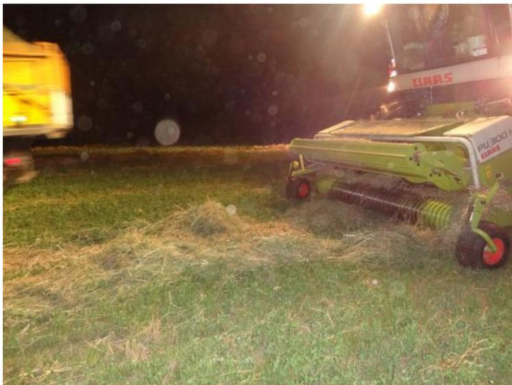
**Figura 2: detalle del recolector de la picadora**
