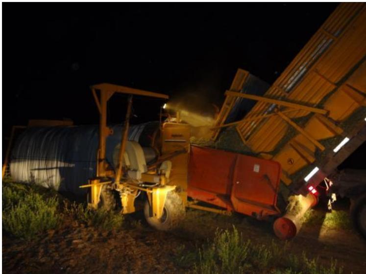
**Figura 6: material descargado a la embolsadora Implecor modificada,**
