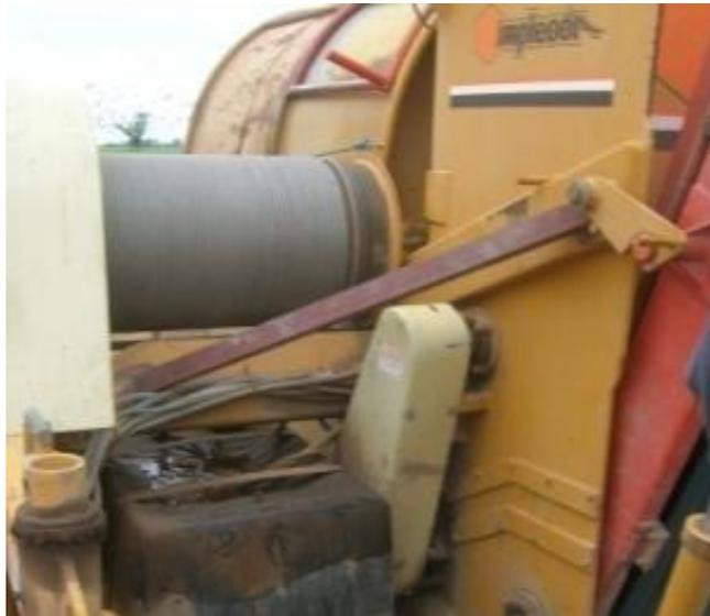
**Figura 12: Reforzado del chasis con puntales laterales**
