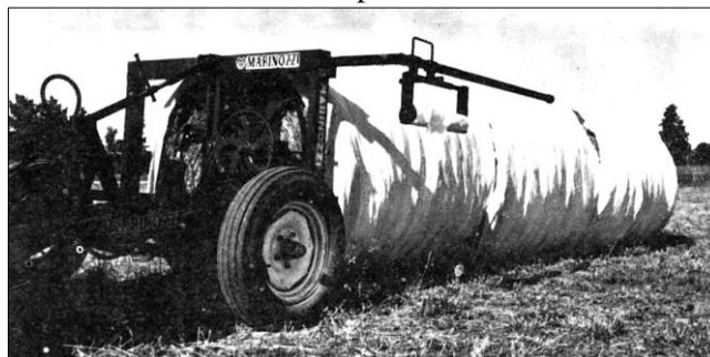
Figura 41: Máquina envolvente de rollo depositando los rollos con sus caras planas enfrentadas para evitar daños ocasionados por los factores climáticos.
