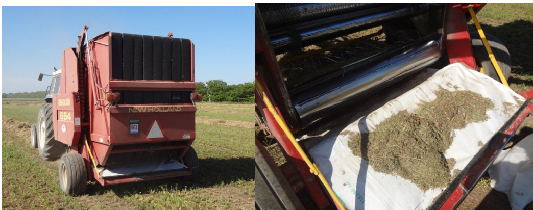
Figura 4: medición de pérdidas en cámara de compactación en rotoenfardadora New Holland 664.
