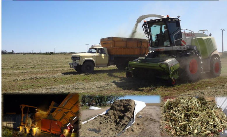
Figura 5: material recolectado por Picadora Claas 960 equipado con recolector PU 300 HD.
