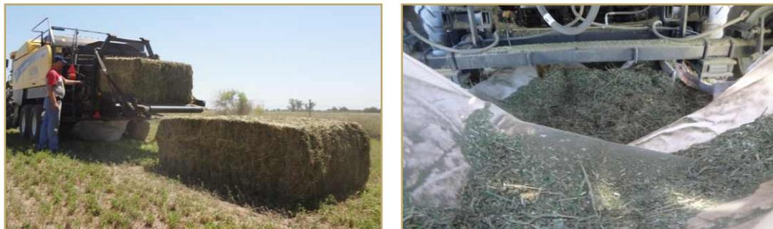
**Figura 15:** Medición de pérdidas en cámara de compactación en Megaenfardadora BB9070 con y sin CropCutter.
