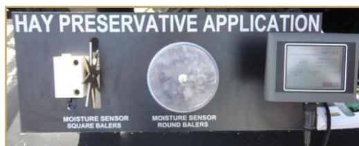
Figura 10: detalle del sensor de humedad.
