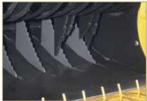
Figura 3: detalle de sistema CropCutter (CNH, 2011).
