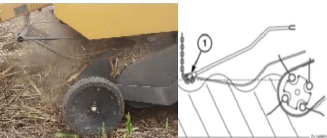
**Figura 8:** vista lateral de recolector. Detalle de protector antiviento. Fuente: AGCO Argentina SA, (2011).
