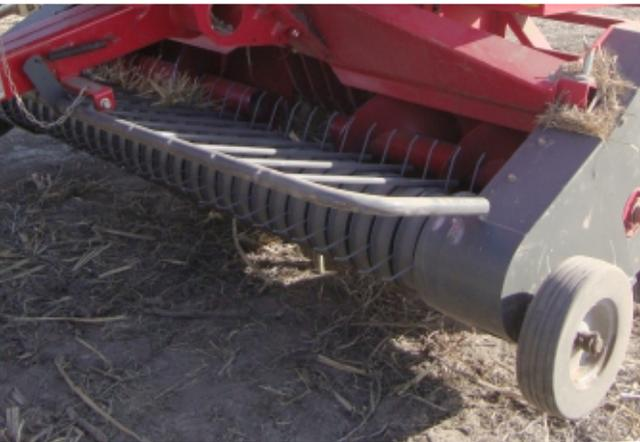
**Figura 22:** detalle del recolector de enfardadora. El material es conducido al centro de la máquina.
