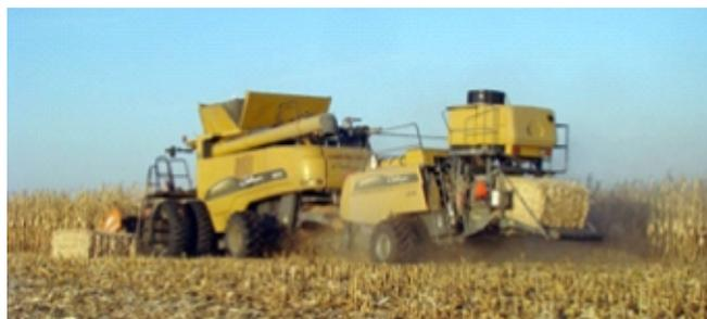
**Figura 25:** Cosechadora con cabezal maicero especial que corta la planta desde el 8<sup>o</sup> nudo hacia arriba y que trabajan en tándem con una megaenfardadora provista de motor propio y que henifica el material no grano que sale por la cola de la cosechadora (marlo, chala y un tercio de los tallos)
