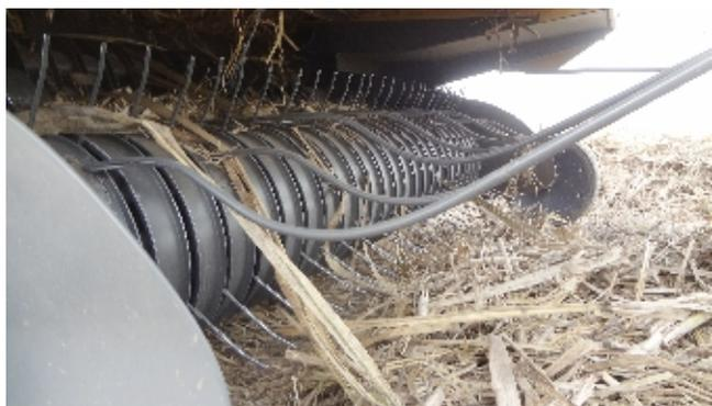
Figura 6: detalle de recolector Rotoenfardadora.
