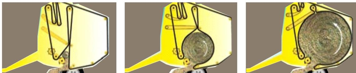
**Figura 11:** Esquema que muestra el proceso de alimentación y formación del rollo. Fuente: AGCO Corporation, 2011.
