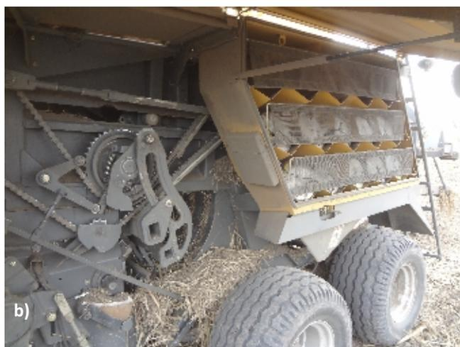
Figura 18: a) detalle del sistema doble atador. b) almacenamiento de bovinas.
