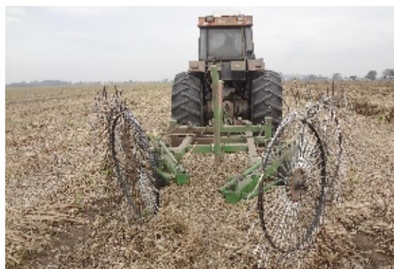
Figura 2: andana conformada por el rastrillo estelar. Detalle del rastrillo con 4 estrellas.
