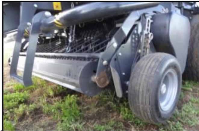
**Imagen 7:** Rodillo flotante de pre-compresión del forraje que mejora las condiciones de recolección.
