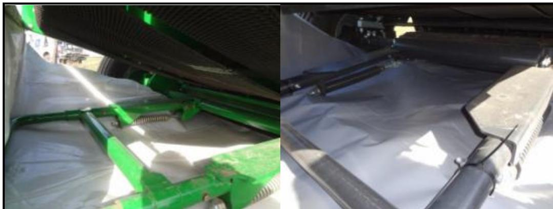
**Figura 26:** Detalle de bandeja recolectora de pérdidas en cámara de compactación en rotoenfardadora Montecor (izquierda) y Galigniani (derecha).
