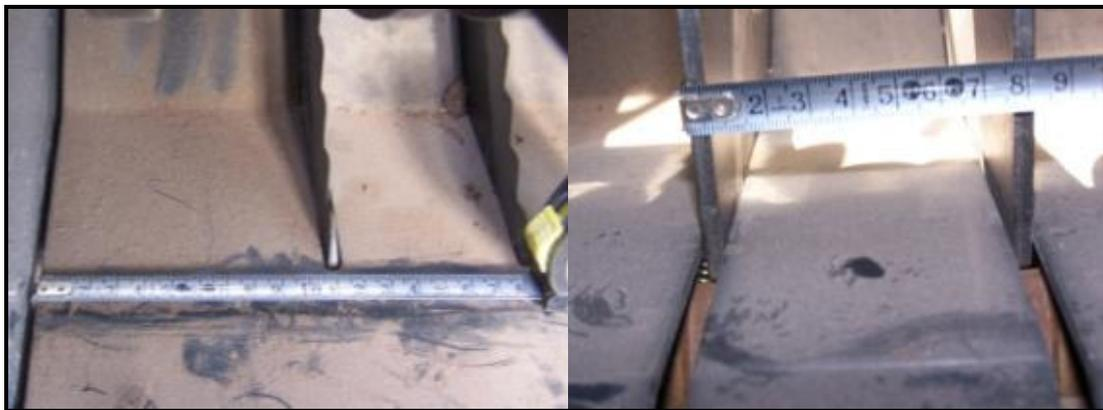
**Imagen 10:** Detalle del piso del rotor donde se pueden colocar cuchillas cada 7 cm dejando 11 cm en los laterales.
