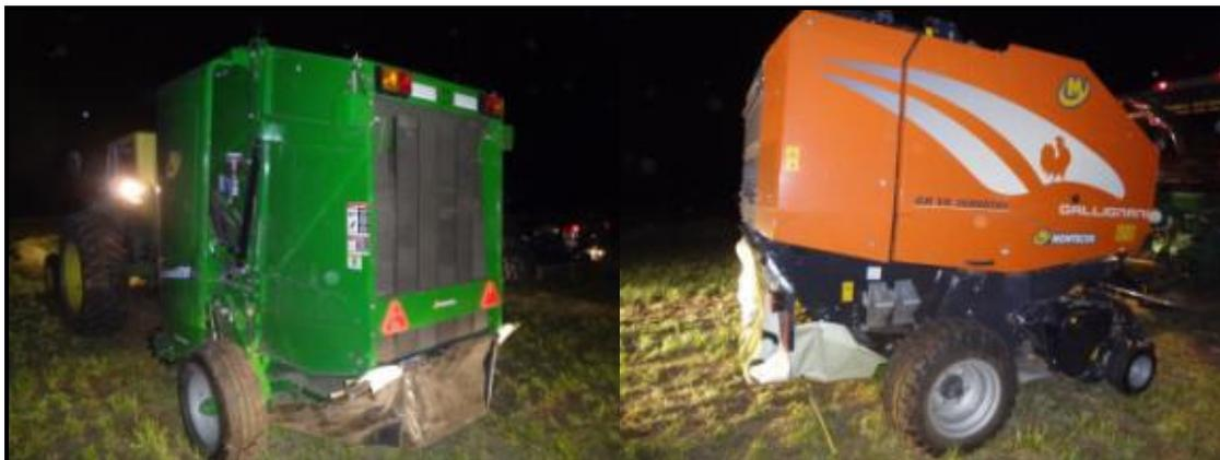
**Figura 25:** A la izquierda rotoenfardadora Montecor 8520 con bandeja de lona. A la derecha rotoenfardadora Galligniani con bandeja de lona.
