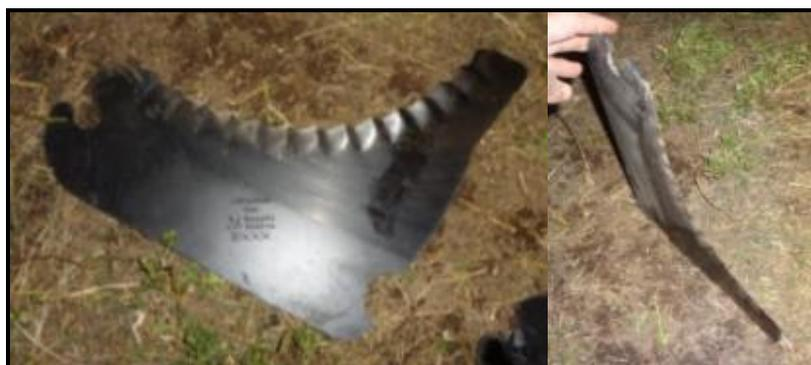
**Imagen 11:** Detalle de cuchilla dentada.
