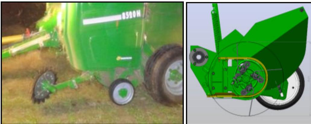
**Imagen 16:** La máquina cuenta con recolector flotante con ruedas pivotantes de copiado.
