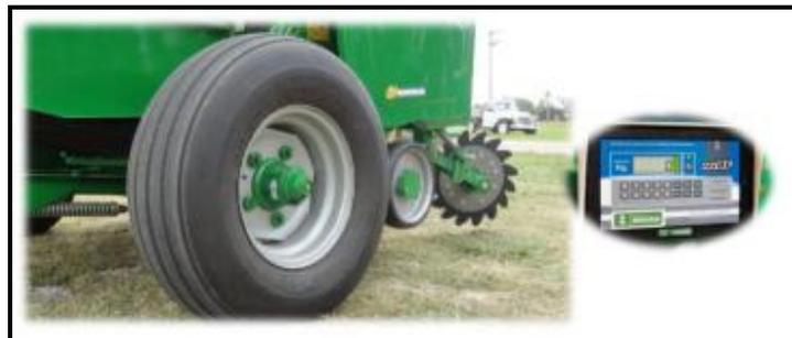
**Imagen 24:** Rotoenfardadora equipada con sistema de pesaje de rollos.
