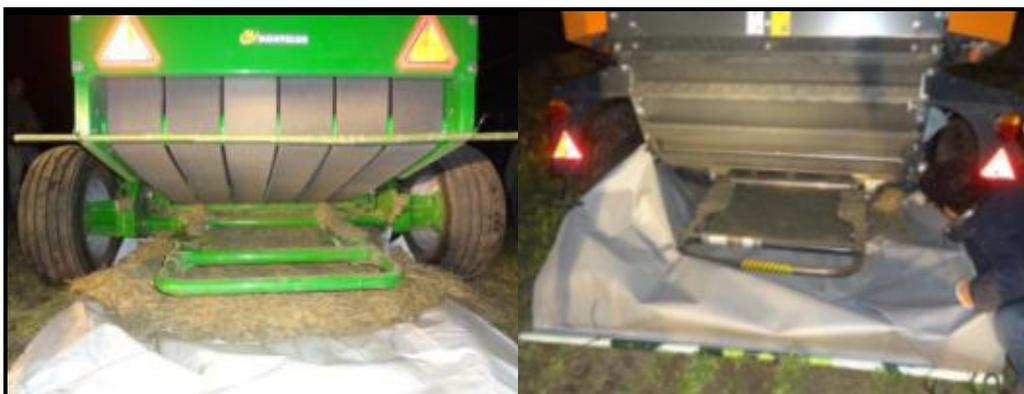
**Figura 27:** medición de pérdidas en cámara de compactación. Rotoenfardadora Montecor. (izquierda), Galligniani (derecha).
