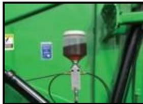
**Imagen 23:** Depósito de aceite del sistema de lubricación centralizado.
