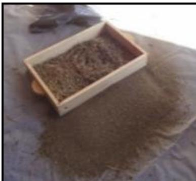
**Imagen 28:** Separación de fracción tierra con tamiz de 2x2 mm.
