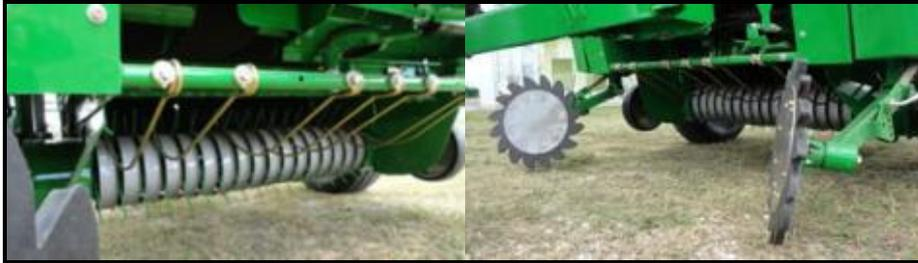
**Imagen 15:** Recolector flotante con deflector superior y ruedas de alimentación lateral.
