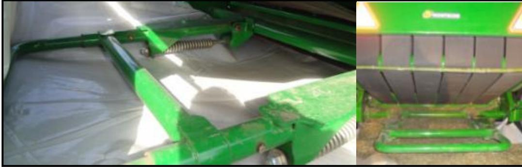
**Imagen 22:** Sistema de expulsión por bandeja de descarga.
