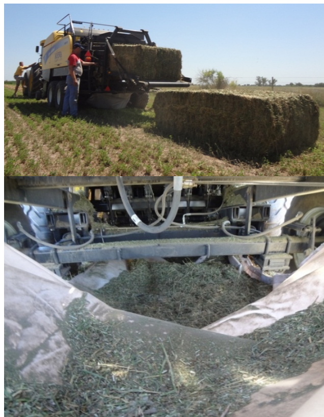
Figura 4: Ensayo de medición de pérdidas en cámara de compactación en megaenfardadora.
