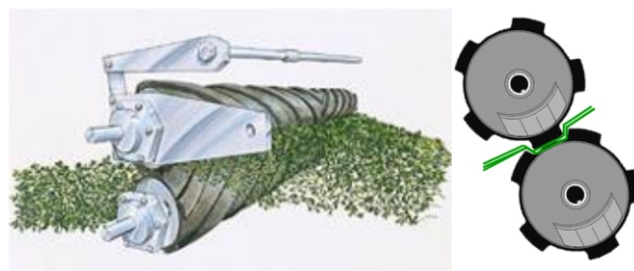
Figura 1: Esquema de trabajo de un sistema de acondicionado mediante rodillos. (New Holland 2011).
