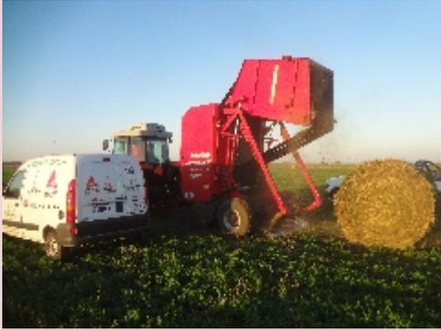
Figura 17: Rollo confeccionado a 180 Bar de presión.
