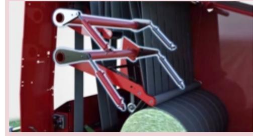
Figura 14: detalle del los brazo de densidad del rollo y los brazos de tensión de correa. Fuente: AGCO Corporation, 2011.
