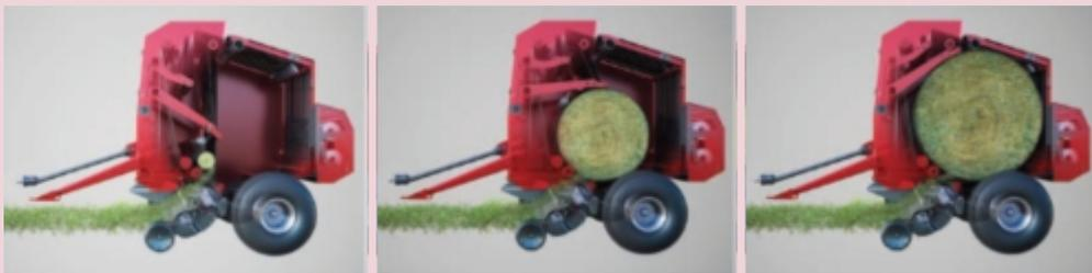
Figura 15: Esquema que muestra el proceso de alimentación y formación del rollo. Fuente: AGCO Corporation, 2011.
