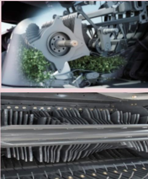
Figura 22: detalle de rotor alimentador de forraje, su función es acelerar el material hacia el interior de la pre-cámara
