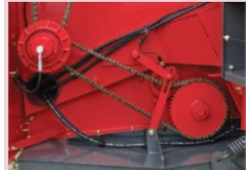
Figura 16: embrague de perno radial.
