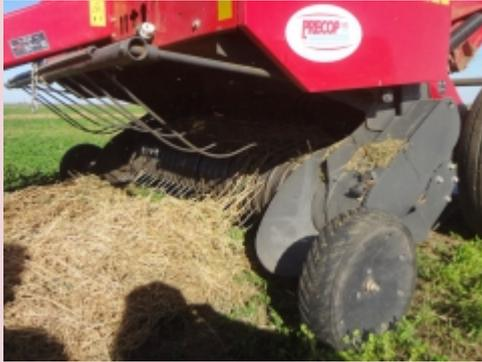
Figura 10: detalle de recolector Rotoenfardadora.
