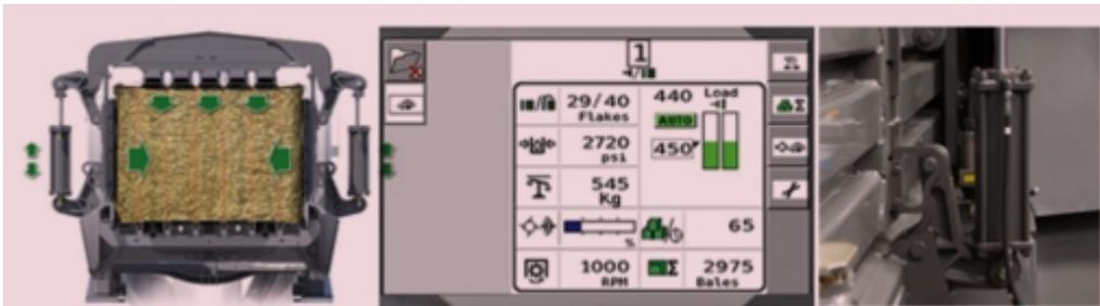
Figura 26: Los cilindros hidráulicos de densidad de doble efecto aplican presión a ambos lados y a la parte superior de la cámara para proporcionar a las pacas una densidad homogénea, todo ello controlado de forma automática a través del monitor de empacadora C1000.
