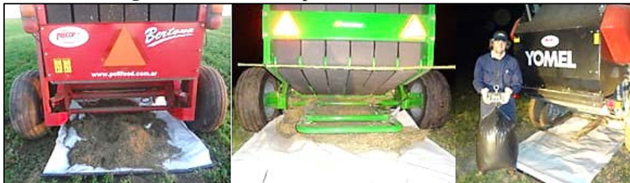
Figura 2: medición de pérdidas en rotoenfardaoras
