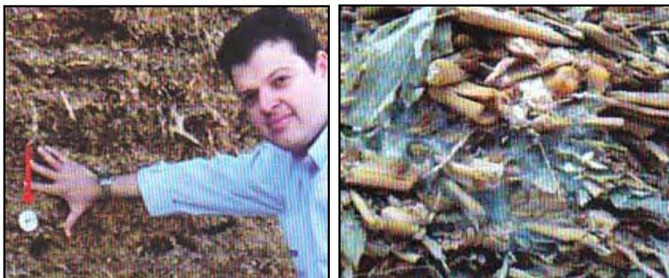
Foto N° 1.- Termómetro de 30 cm de largo fijado en la cara del silo para mediciones de temperatura;
