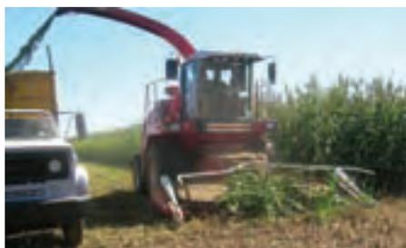
*La altura de corte es fácilmente manejable con la regulación del cabezal de la picadora.*
