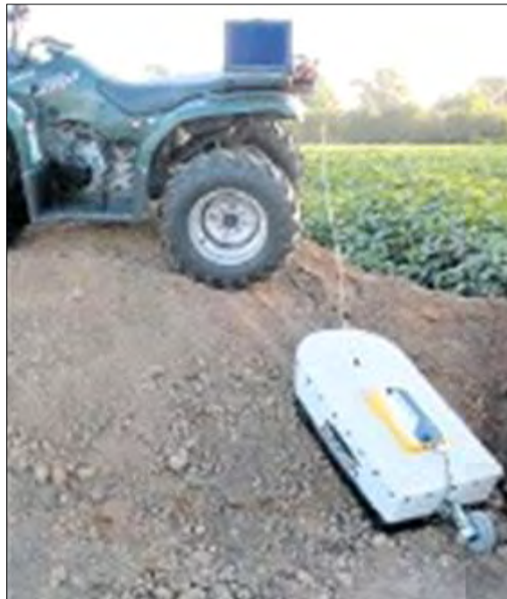
Georradar para napas. Foto: gentileza A. Marchionni
