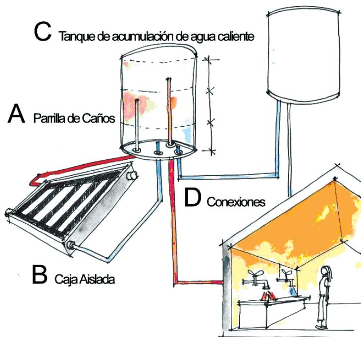
Las partes que conforman el colector solar de agua son:
