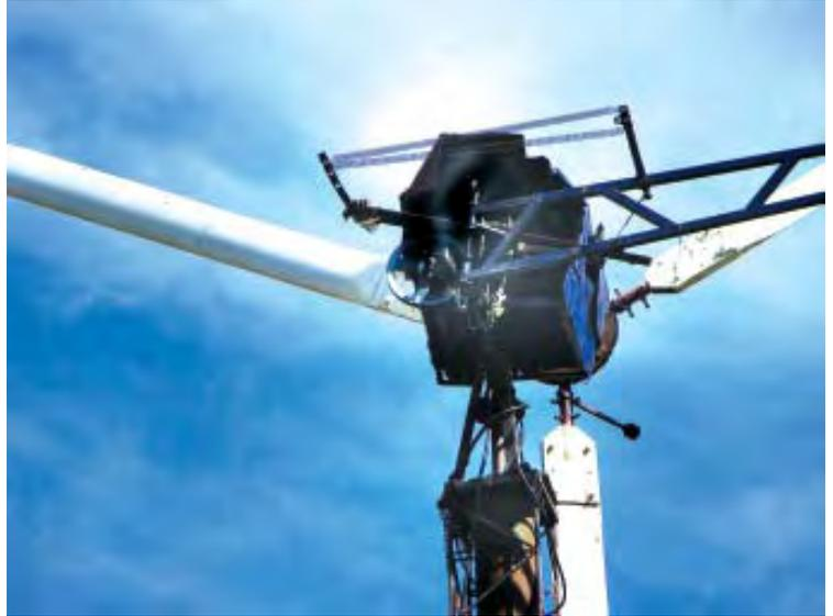
La idea de los molinos con transmisión oleohidráulica es que permiten obtener un elevado rendimiento de la energía generada en el molino y una gran diversidad de usos por medio de motores hidráulicos.
