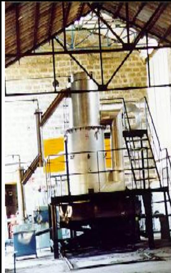
**Figura A6: Proyecto Orchha utilizando un Gasificador Netpro de 100kW (Gasificador IISc)**
