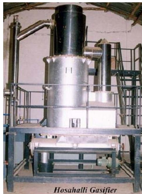
Figura A8: Gasificador de biomasa en Hosahalli.
