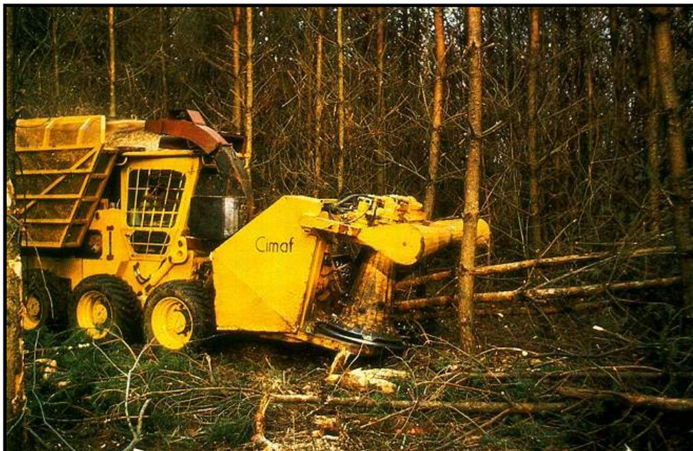
Figura 11. Recolector de biomasa forestal y “chipeador” autopropulsado
