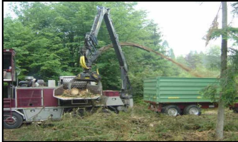
Figura 5. Astillado “*in situ*” de los residuos de apeo para su transporte.
