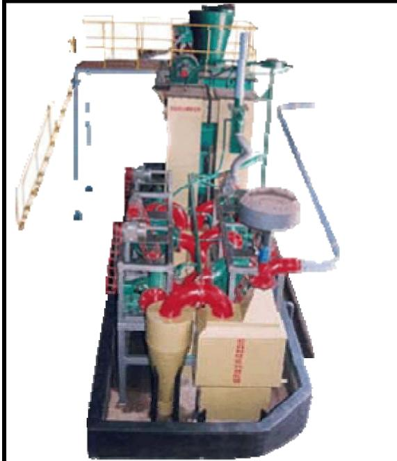
**Figura A5: Sistema AEW de 100kWe para biomasa leñosa, mostrando el equipamiento para limpiar el gas.**
