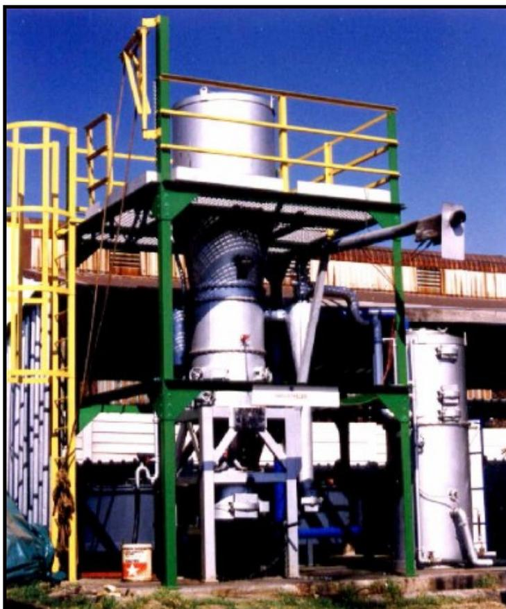
Figura H1. Instalación de un Gasificador Carboconsult en Sebenza<sup>39</sup>.
