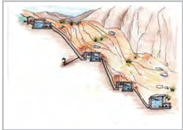
Disposición de las cámaras rompecargas en un sistema de conducción. Fuente: García, Op. cit. (2013).
