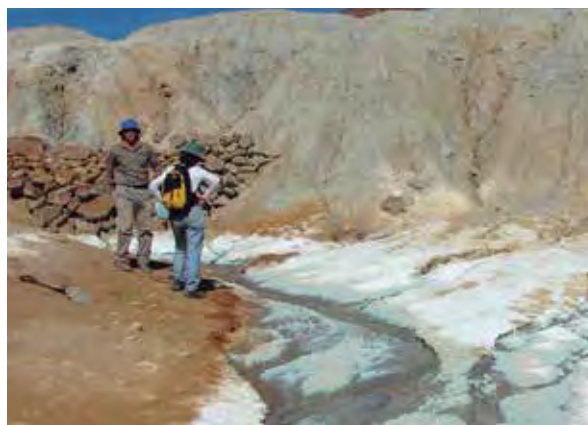
Drenaje ácido en la mina Pan de Azúcar: pH 2,1 y precipitados celestes de melanterita (sulfato de Fe y Zn), mineral secundario formado por evaporación del drenaje ácido.
