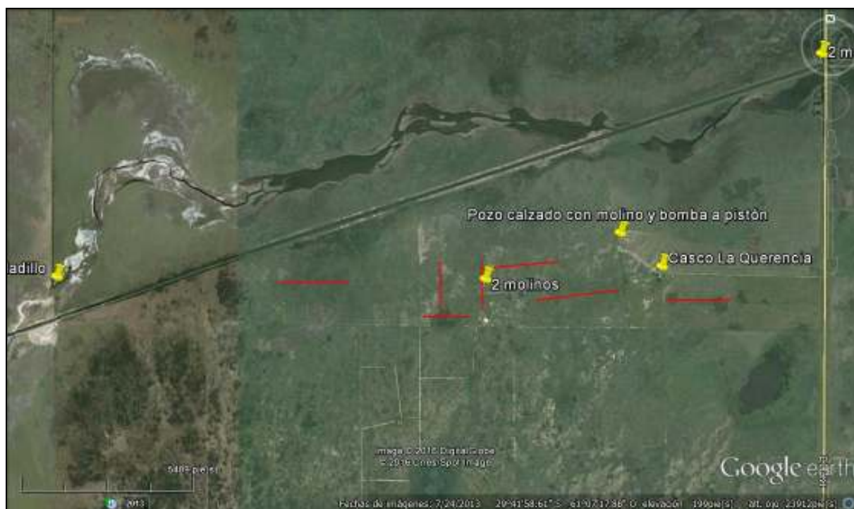
Imagen satelital que identifica el sector sur del Establecimiento, el Casco, aguadas actuales y propuesta de estudios de prospección geoelectrica (trazas rojas).
