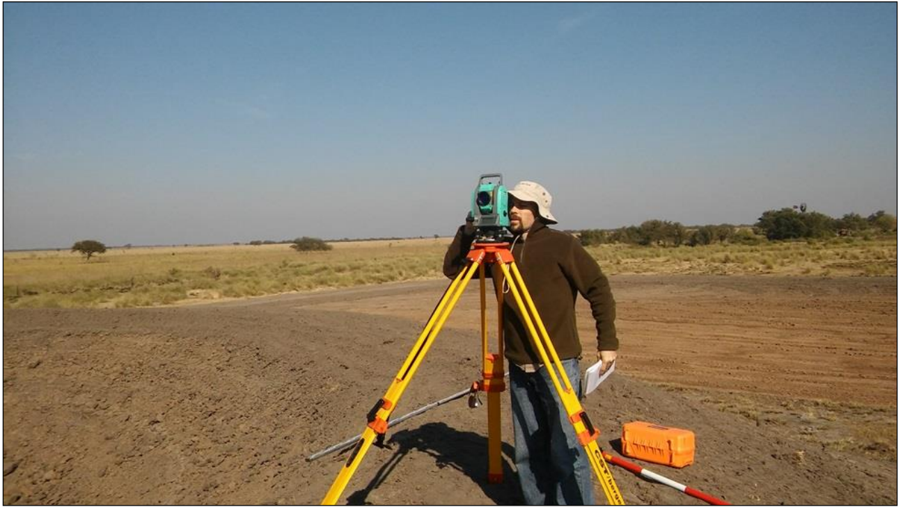
Mediciones planialtimétricas de alta precisión tomadas por el Ing. Luciano Sánchez.
