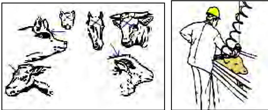
a) Posiciones correctas para la aplicación de la pistola de perno retráctil; b) Pistola de noqueo de perno retráctil, colocada en la posición correcta de la cabeza del novillo
