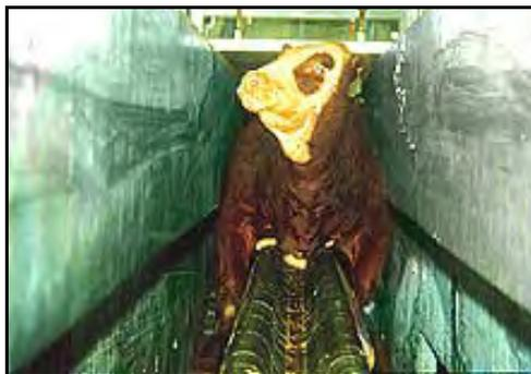
Figura 1: Un novillo está montado en calma sobre la línea de transporte central, que está diseñada para amoldarse al pecho. El techo sobre la cabeza del novillo debe ser lo suficientemente largo para bloquear su visión hasta que sus patas traseras ya no se apoyan sobre la rampa de entrada. El ancho máximo de la línea de transporte es 30 cm.
