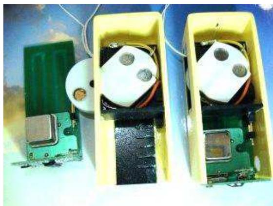
**Figura 10.** Vista del dispositivo sensor sin la tapa inferior transmisor y circuito electrónico decodificador
