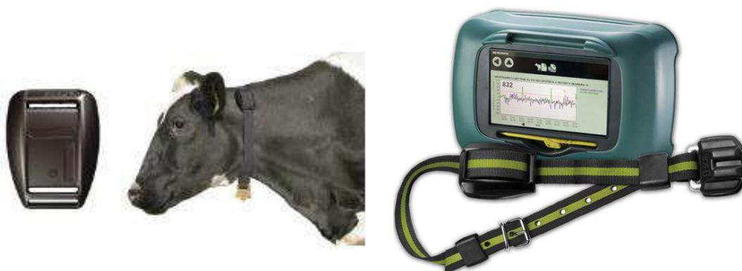
**Figura 7.** Sistema de detección del tiempo de rumia (HeatimeRuminac®).
