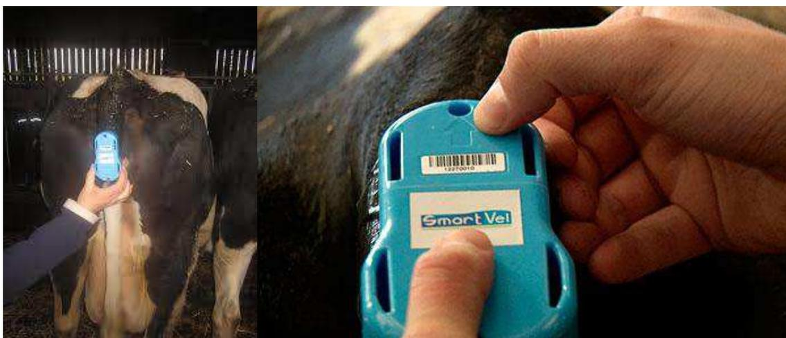
**Figura 2.** Sistemas de alerta de partos basados en el movimiento de la cola (Sistema Smart´Vel®).
