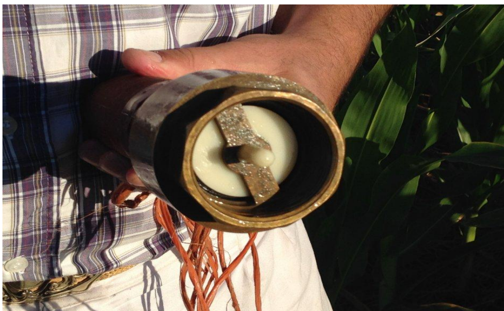
Foto 4. Dispositivo construido con válvula de paso de plomería.
