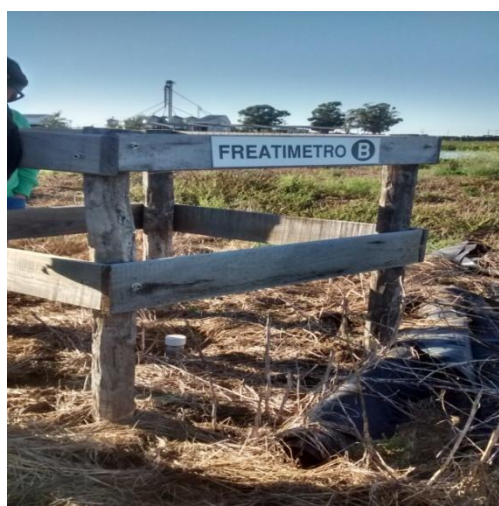
Foto 3. Ejemplo de clausura e identificación de freatímetro mediante “corral de madera”.
