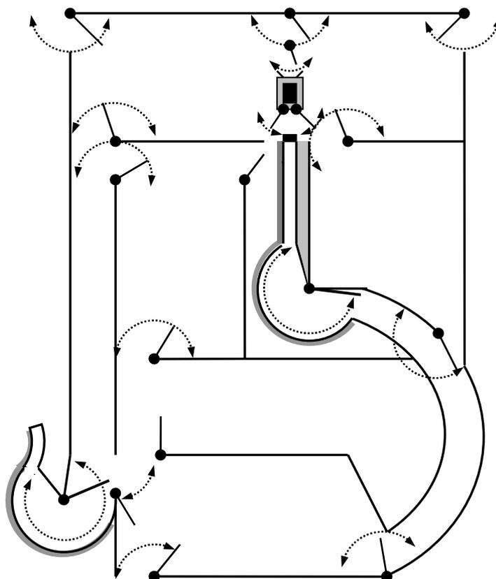
Esquema C. Con manga recta, toril redondo y mangón largo con cargador con corral reloj (Alta capacidad de carga con callejón para el cargador. Mejor flujo en callejones y mangón que en A y B)
