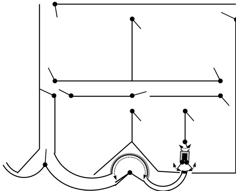
Esquema E. Manga circular en lateral del área de corrales, con toril reloj y mangón circular, cargador con reloj semi circular con callejones de alta circulación (Máxima funcionalidad por estructuras circulares, diseño simple de corrales de apoyo y menor costo que los anteriores)
