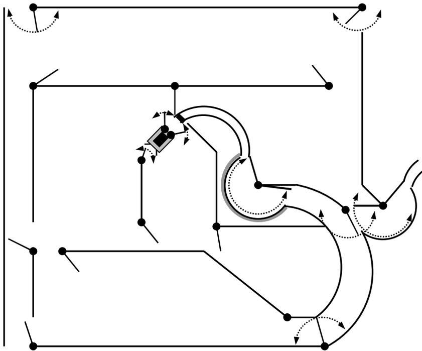
Esquema D. Manga circular, toril reloj y mangón circular, combinado con cargador con reloj (Alta funcionalidad por estructuras circulares y diseño simple de corrales de apoyo)
