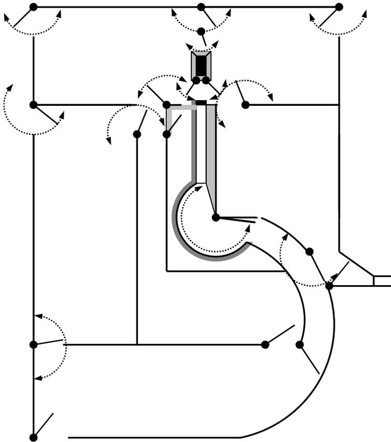
Esquema B. Con manga recta en el centro, toril redondo, mangón circular y cargador vinculado al mangón (el mangón facilita la carga de animales)
