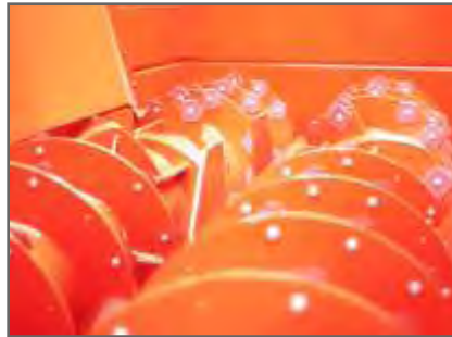
Figura 2.21. Dos sinfines horizontales con cuchillas periféricas.
