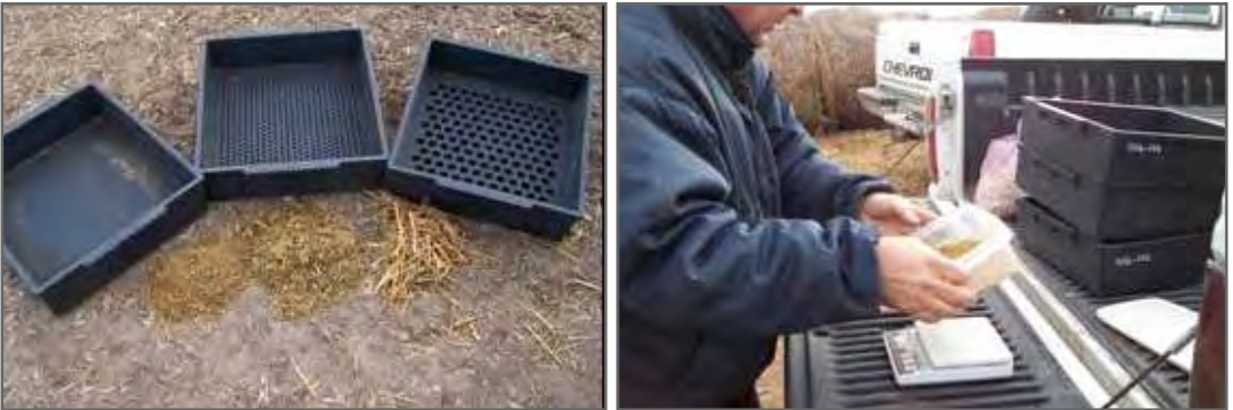
Figura 4.6. La bandeja superior (izquierda), tiene orificios que retienen partículas mayores a 2 cm, la del medio tiene orificios más pequeños que retienen las partículas cuyos tamaños van de 0.8 a 2cm y la bandeja del fondo es ciega (1ª de la izquierda) y por lo tanto allí quedan las partículas menores a 0.8 cm.
