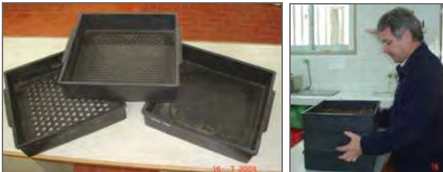
Figura 2.35. Derecha: Zarandas de Separador de Partículas “Penn State”. Izquierda: procedimiento de trabajo con una TMR.
