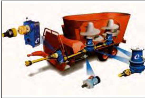
Figura 2.13. Componentes mecánicos y de transmisión de un mixer moderno de dos sinfines de mezclado (Fuente: INTA PRECOP, 2009).
