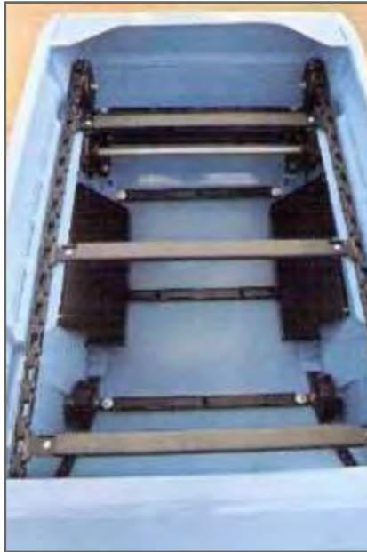
Figura 2.29. Sistema mezclador por rastra giratoria periférica.
