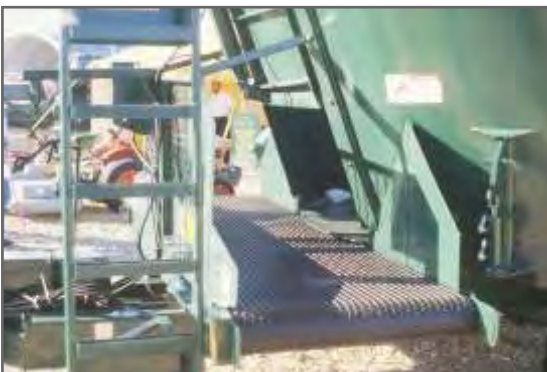
Figura 2.7. Sistema de descarga frontal con cinta de caucho que permite entregar el forraje a ambos lados del acoplado.
