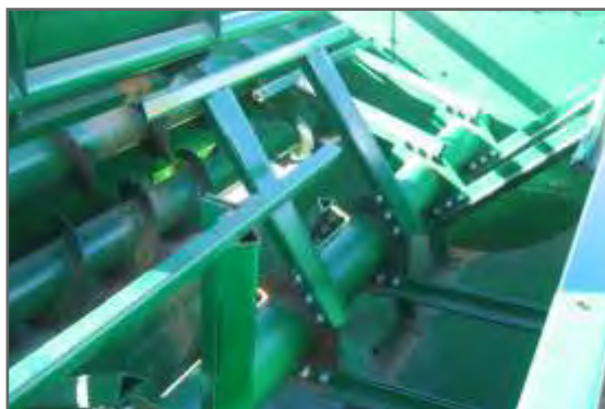
Figura 2.26. Interior de mixer de mezcla vertical con paletas divididas, para repartir el esfuerzo y sinfines las el traslado longitudinal del forraje.
