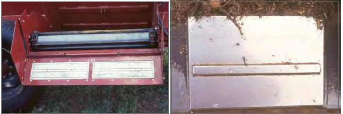
Figura 2.9. Trampas de metal para prevenir accidentes por la ingestión de cuerpos metálicos en la ración.
