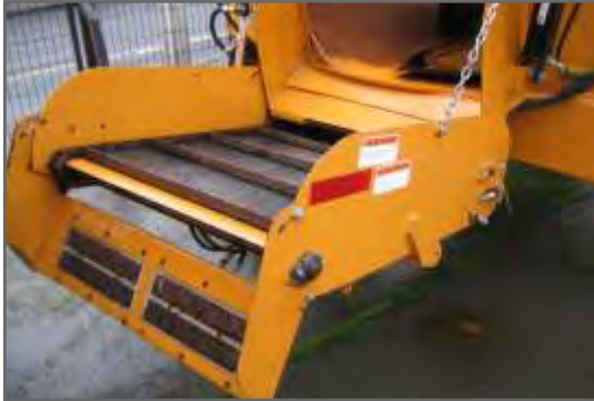
Figura 2.6. Sistema de descarga, de noria con barras y cadenas.
