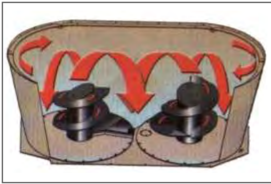
Figura 2.14. Doble sinfín de mezclado en acoplado de mayor capacidad de carga y trabajo (Fuente: INTA PRECOP, 2009).
