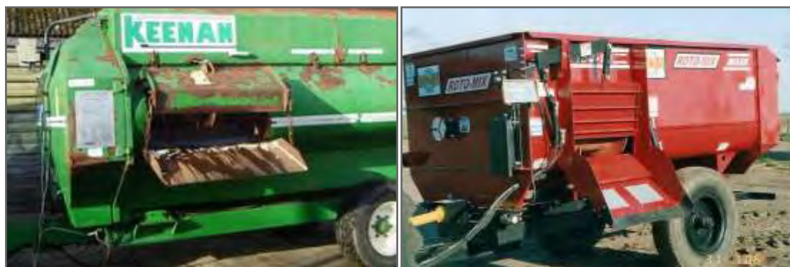
Figura 2.4. Sistema de descarga por gravedad utilizando la inercia del material durante el mezclado.
