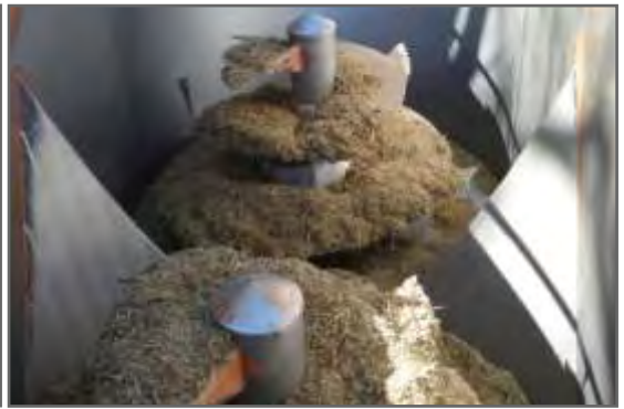
Figura 2.14. Doble sinfín de mezclado en acoplado de mayor capacidad de carga y trabajo (Fuente: INTA PRECOP, 2009).
