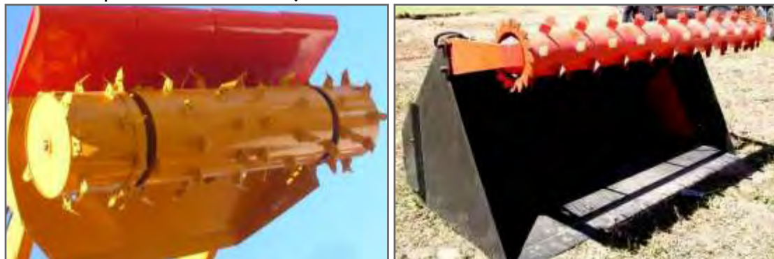
Figura 2.32. Izquierda: Freza de autocarga de un mixer horizontal moderno. Derecha: Freza de autocarga incorporada a una pala frontal.
