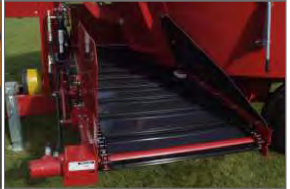
Figura 2.6. Sistema de descarga, de noria con barras y cadenas.
