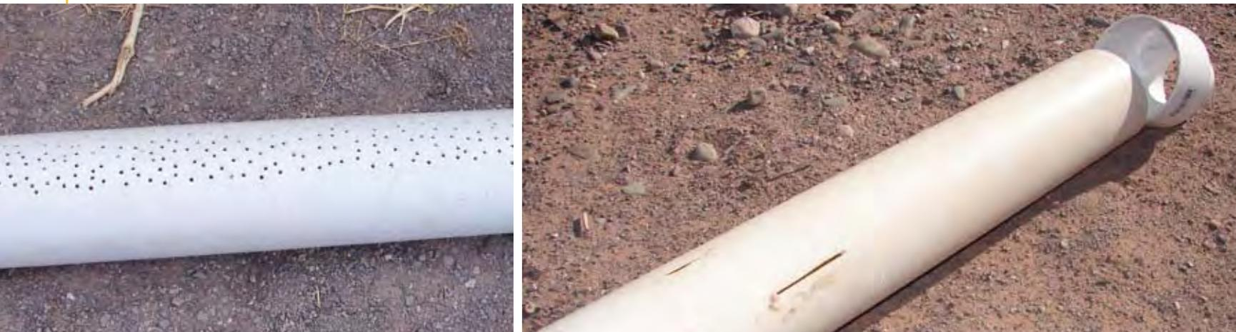
Caño perforado y caño ranurado; se observa la canaleta y la parte colectora
