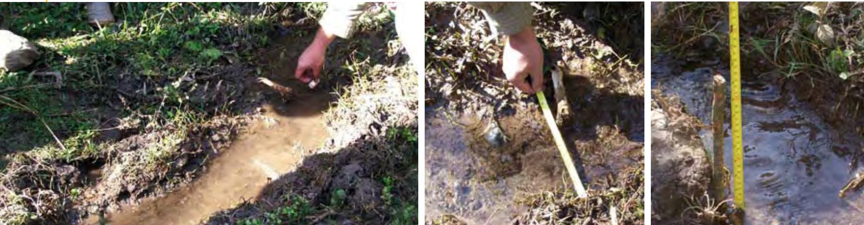
Medición del caudal determinando el velocidad y la sección
