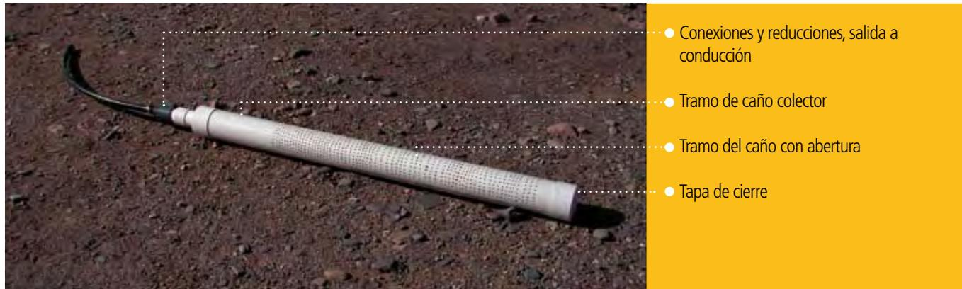
En el extremo posterior del caño se coloca una tapa de cierre. De esta forma tendríamos el caño filtrante construido. Otra manera de conectar el caño al sistema es mediante una abrazadera de derivación colocada en la parte no ranurada (colectora), cerrando ambos extremos del caño con tapas.
