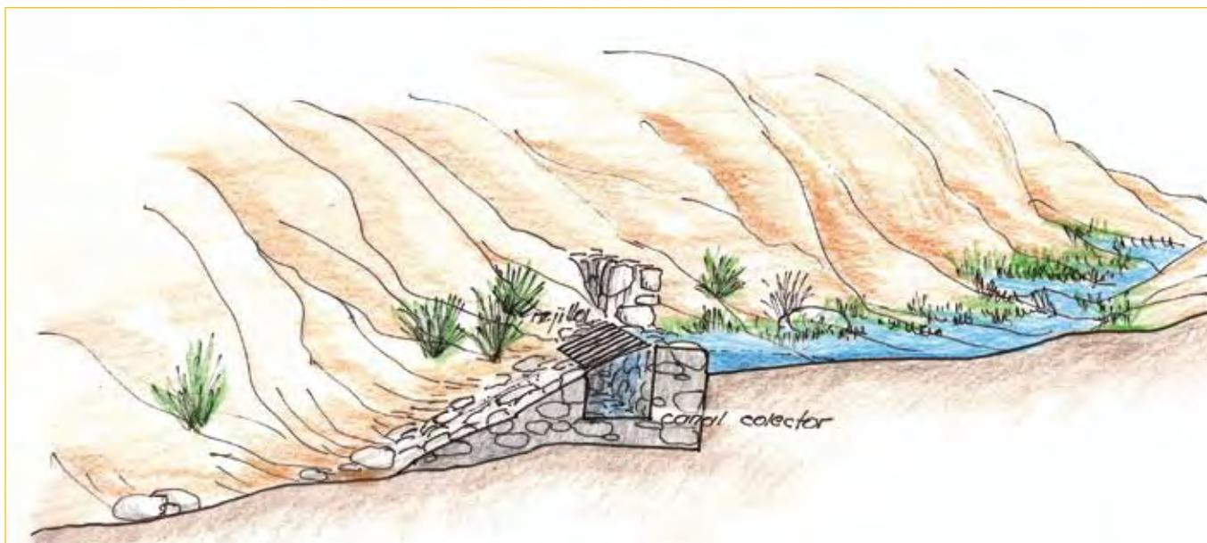
Esquema del sistema mediante toma rejilla en una quebrada.
