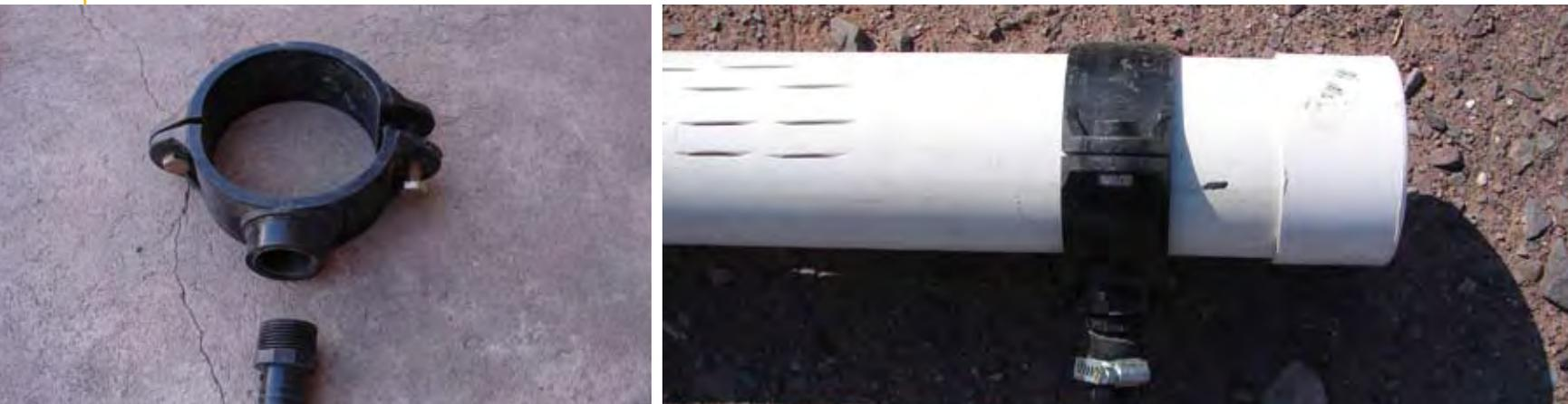
Conexión mediante abrazadera de derivación.
