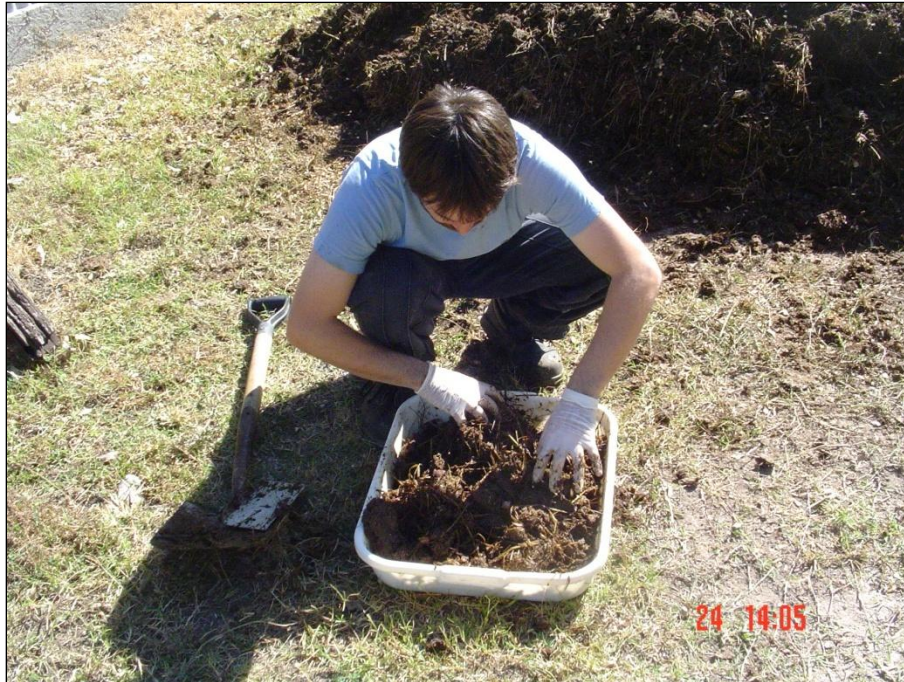
Figura 9: Extracción y homogenización de los tres puntos antes del cuarteo
