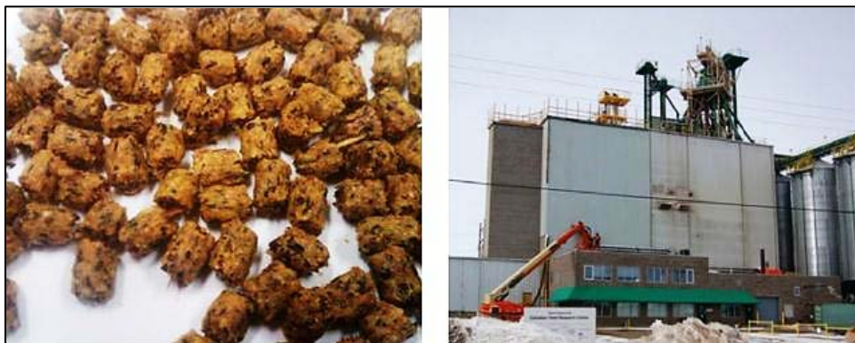
En la imagen de la izquierda, mezcla de semillas de colza completa extruida y trigo (30 % aceite) en la que no se aprecia aceite en el material después de la extrusión. A la derecha, una panorámica del centro canadiense de investigación en pienso (Universidad de Saskatchewan) consta de una nueva línea piloto de pienso (cinco plantas) adosada a un molino de pienso ya existente (capacidad de granulación de 20 t/hora).
