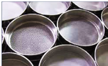
Figura 3. Se utilizan tamizadores de varios tamaños para separar una muestra de alimento triturado por el tamaño de las partículas. Imagen por cortesía de Gilson Company, Inc.
