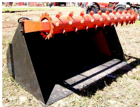
Freza de autocarga incorporada a una pala frontal
