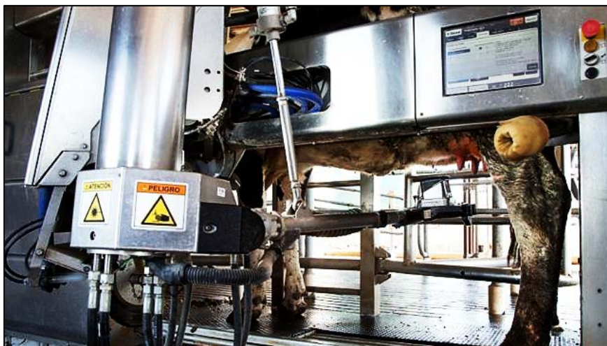
La primera vez que ingresa un animal al sistema se le debe mostrar al brazo robótico la posición de los cuatro pezones. Foto: Diego Lima
