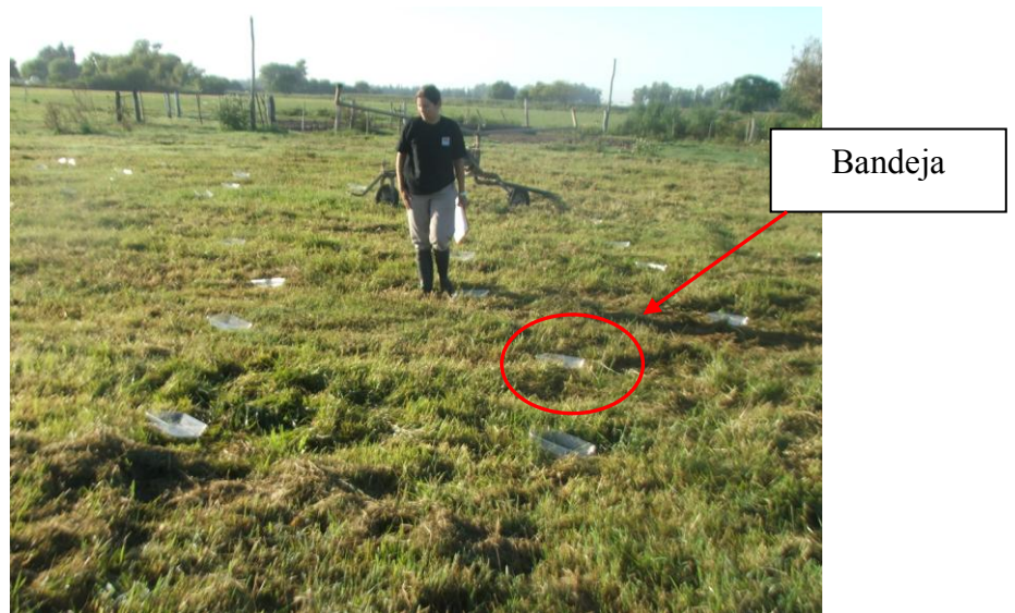
Foto 10: Bandejas alrededor del carro aspersor.
