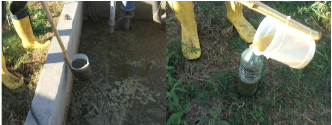
Foto 12: Toma de muestra del efluente.
