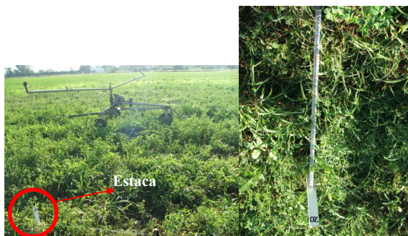
Foto 13: Medición distancia recorrida por el sistema.
