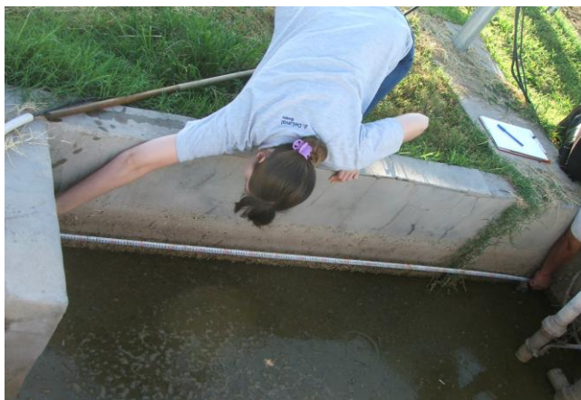
Foto 9: Medición largo y ancho de la cámara de almacenamiento.
