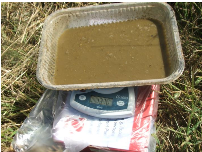
Foto 11: Bandeja pesada sobre balanza digital.
