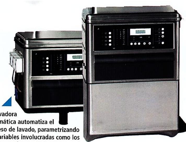
La lavadora automática automatiza el proceso de lavado, parametrizando las variables involucradas como los tiempos, volumen, dosis y frecuencia de los ciclos.
