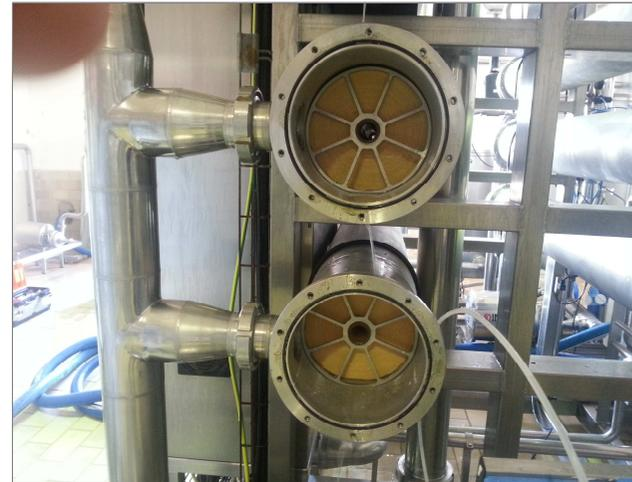
Las membranas que procesan suero, con el paso del tiempo se van poniendo amarillas. En la imagen se ve la comparación entre una membrana usada (más de 10.000 horas de trabajo) y una nueva.
