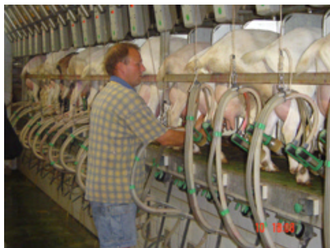
Intalación con medidores electrónicos y retirada automática.
