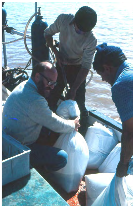
En tren de calibrar la ecosonda, manteniendo sábalos en bolsas plásticas con oxigenación; proximidades del puerto de Nueva Palmira, 1985-1986
