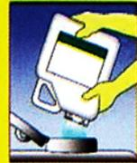
Vierta el agua del envase en el equipo pulverizador. Mantenga el envase en posición de descarga durante 30 segundos.
