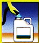
Vacíe el envase en el tanque pulverizador. Mantenga en posición de descarga 30 segundos hasta agotar su contenido. Agregue agua hasta 1/4 de la capacidad del envase.
