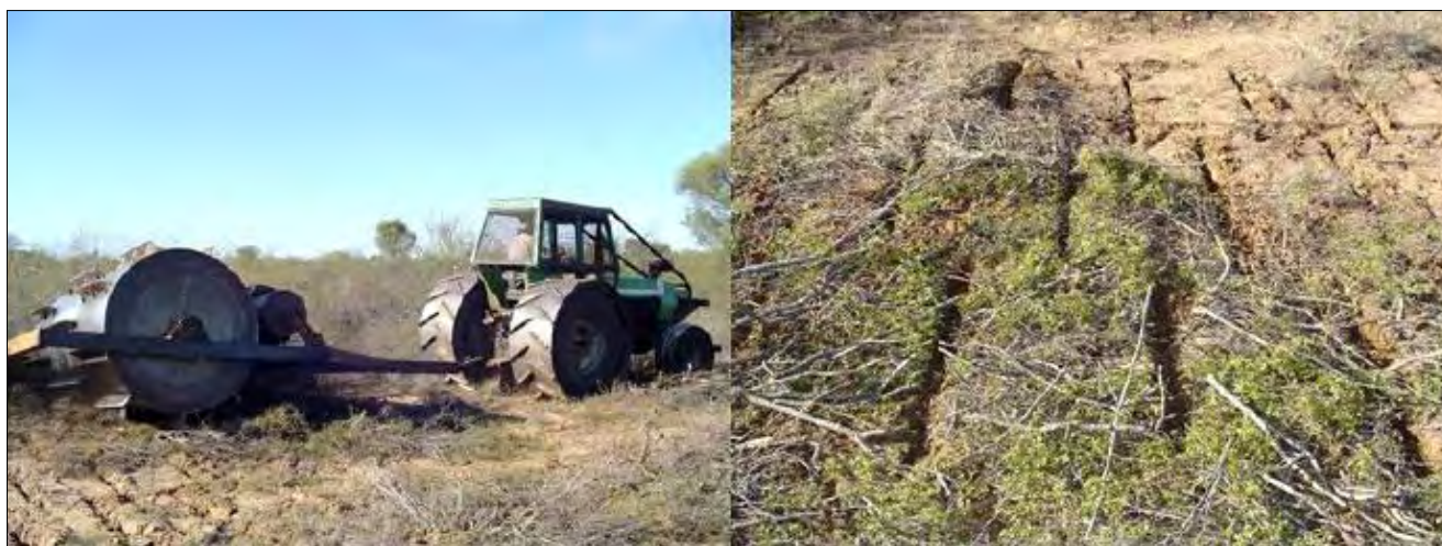
Foto 1: maquinaria comúnmente utilizada para el rolado y siembra de buffel. El tractor blindado moviliza un rolo tradicional que lleva adosado un tambor perforado conteniendo las semillas, al que imprime un movimiento rotatorio. Las cuchillas ejercen un efecto intenso sobre las especies leñosas, pero leve sobre las matas de pastos perennes.
