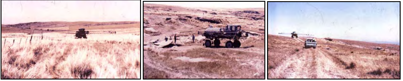
Pulverizador autopropulsado (langosta) aplicando glifosato 2 litros/ha sobre alambrados para hacer contrafuegos (La Fátima, de Pedro Fourcade, Villa del Chacay, Córdoba).
