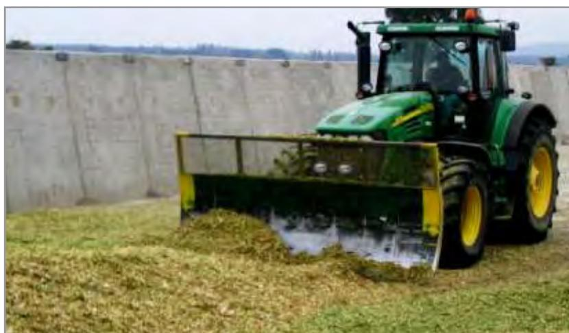
**Figura 6.23.** Los equipos con caja inversora permiten el trabajo en avance y retroceso haciendo el compactado más eficiente.
