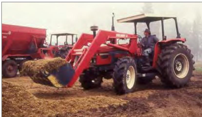
**Figura 11.4.** La menor distancia al frente del tractor y la doble tracción dan seguridad al sistema.
