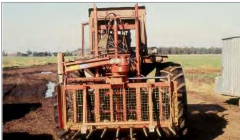
**Figura 11.18.** Cuchillo de extracción de silaje.
