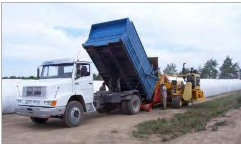
**Figura 8.12.** La facilidad de la descarga agiliza el trabajo haciendo que el llenado del silo sea más ágil.
