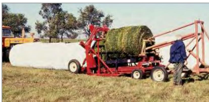
**Figura 5.32.** Una vez comenzado el trabajo no hace falta contar con tope posterior.
