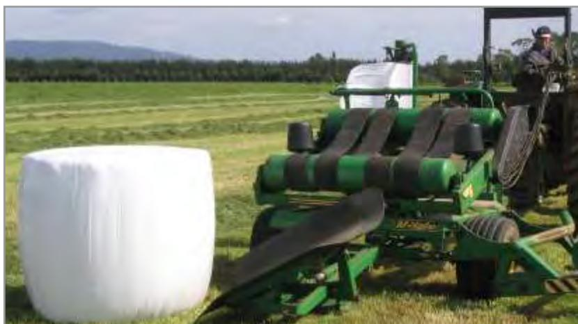
**Figura 5.25.** Rampa e descarga de doble acción que permite depositar el rollo parado sobre su cara plana.
