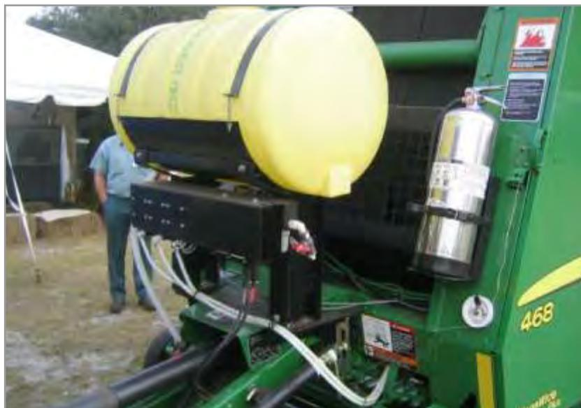
**Figura 4.61.** Equipo de aplicación de conservante.
