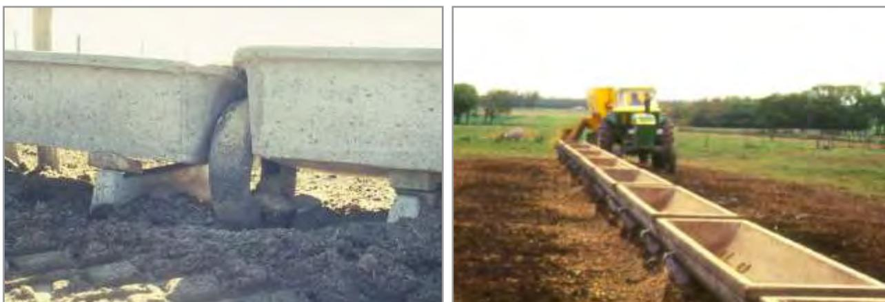
**Figura 11.39.** Cuando se utilizan estructuras fijas es importante tener en cuenta dónde se las va a montar, para reducir el riesgo de roturas y bajar su costo de amortización.
