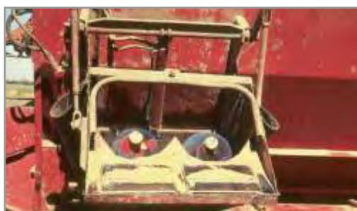
**Figura 11.22.** Descarga por sinfines.
