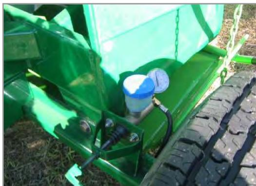
**Figura 10.31.** Regulación del freno hidráulico en las ruedas.
