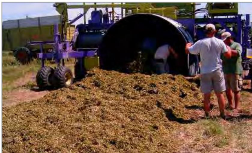
**Figura 10.34.** Vaciado del túnel de compactación.
