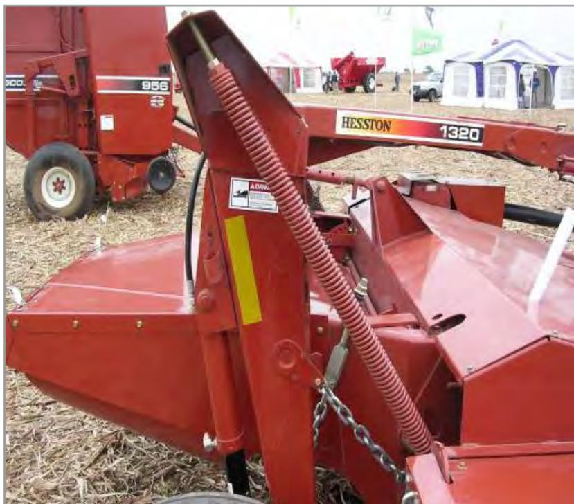
**Figura 4.26.** Resortes de flotación en los que se encuentra suspendida la plataforma de corte.
