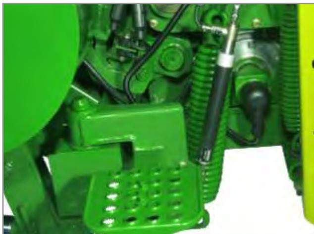
**Figura 7.32.** Ubicación de sensor de flujo de forraje.
