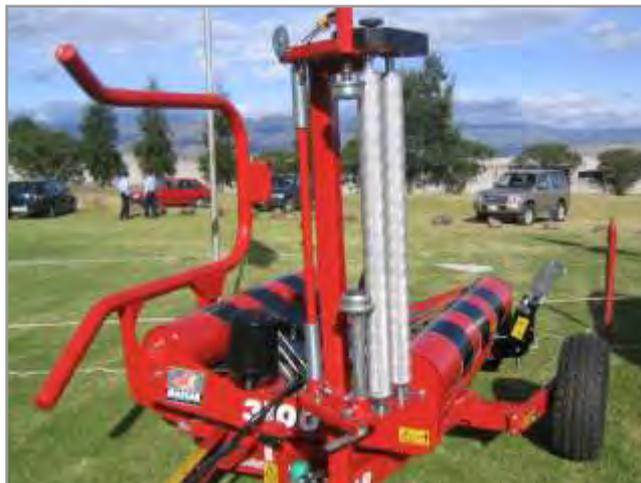
**Figura 5.28.** Portabobina, para film de 1 m de ancho.
