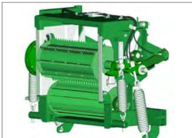
**Figura 7.15.** Esquema de los resortes de tensión de los rodillos de alimentación.
