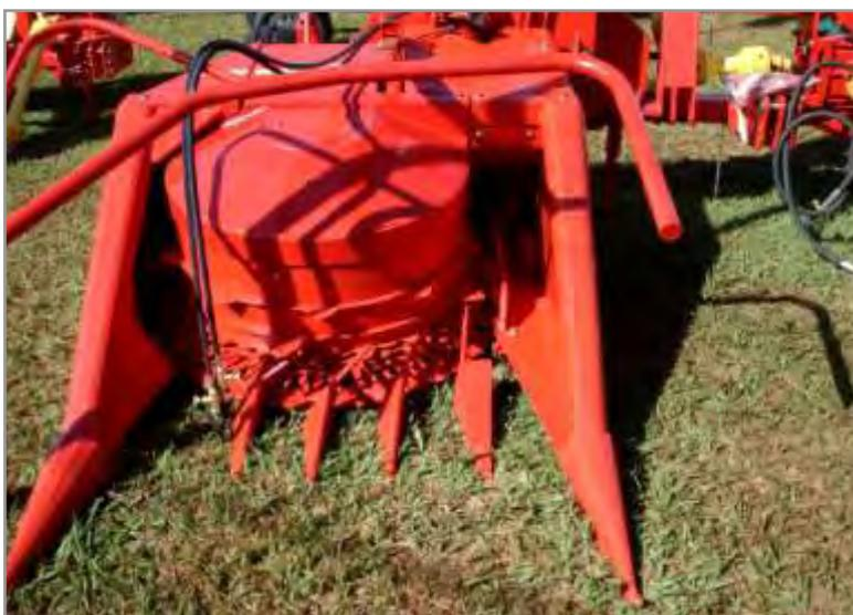
**Figura 6.19.** Cabezal rotativo de una máquina de arrastre.
