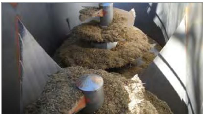
**Figura 11.36.** Doble sinfín de mezclado en acoplado de mayor capacidad de carga y trabajo.
