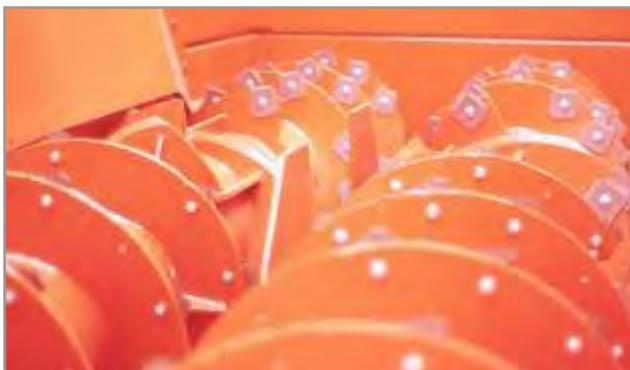
**Figura 11.29.** Dos sinfines horizontales con cuchillas periféricas.
