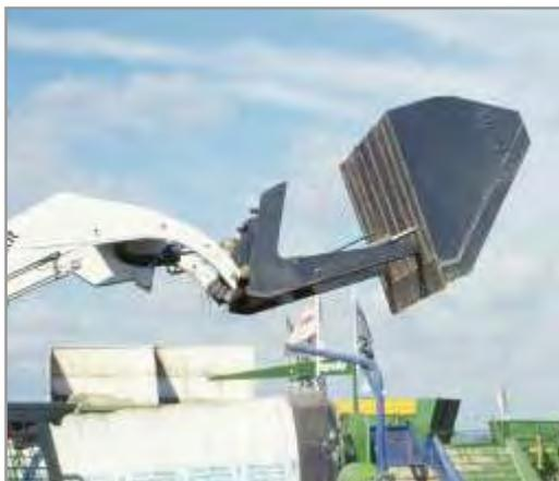
**Figura 11.10.** El movimiento de la parte posterior del balde es más conveniente que el descenso del frente.
