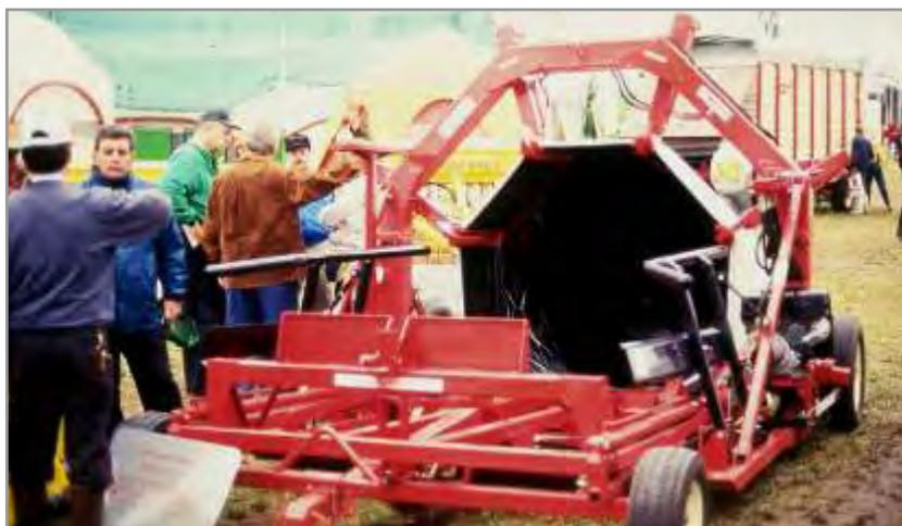
**Figura 5.29.** Vista de la embolsadora con motor incorporado.
