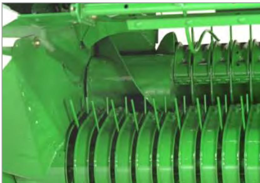
**Figura 4.76.** Sinfín de alimentación lateral del recolector ancho.
