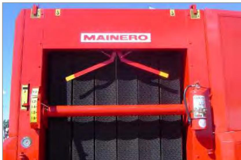
**Figura 4.87.** Señales mecánicas en la rotoenfardadora.
