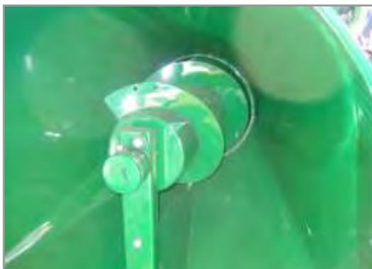
**Figura 10.29.** Sinfín de compactación dentro del túnel.
