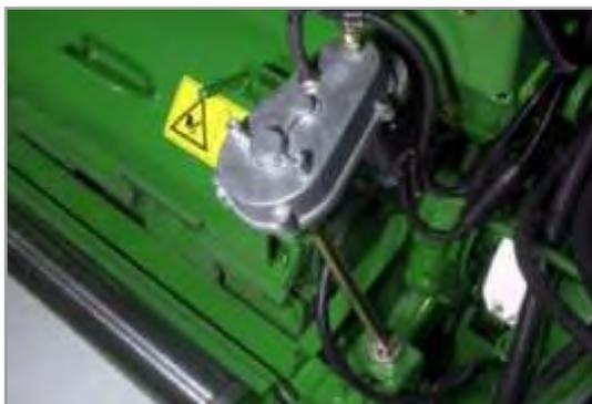
**Figura 7.25.** Mecanismo de ajuste de la contracuchilla.
