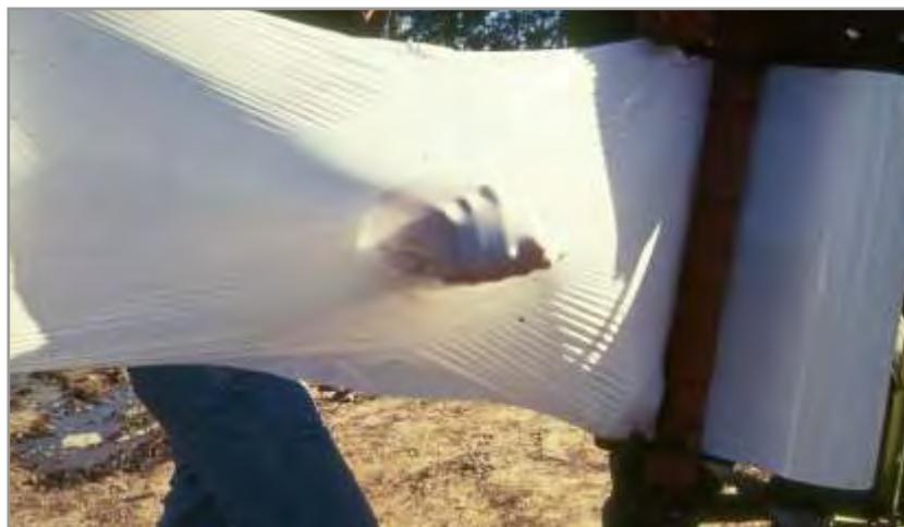
**Figura 5.12.** Prueba de calidad del film. Prueba del puño.
