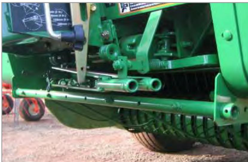
**Figura 4.66.** Sistema de doble aguja que acelera la operación de atado y mejora la calidad del heno confeccionado.
