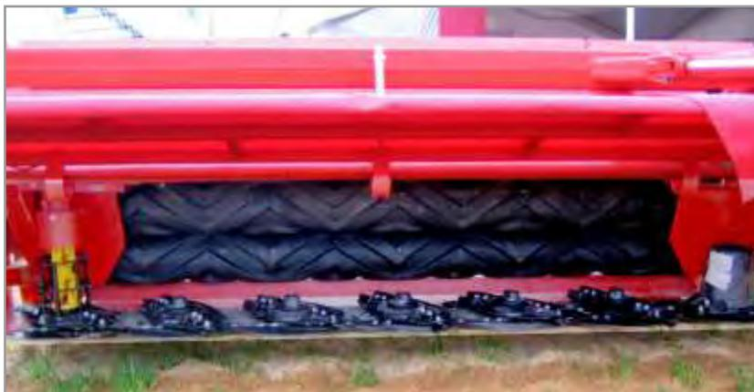
**Figura 4.24.** Cortadora acondicionadora de discos con cuchillas cortas.
