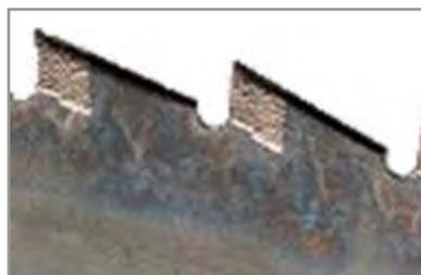
**Figura 7.8.** Sobre el borde del filo, se puede observar la sección que está con tratamiento para endurecer ese sector.
