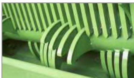
**Figura 10.18.** Detalle de los álabes del rotor con el peine de alimentación al túnel de compactación.
