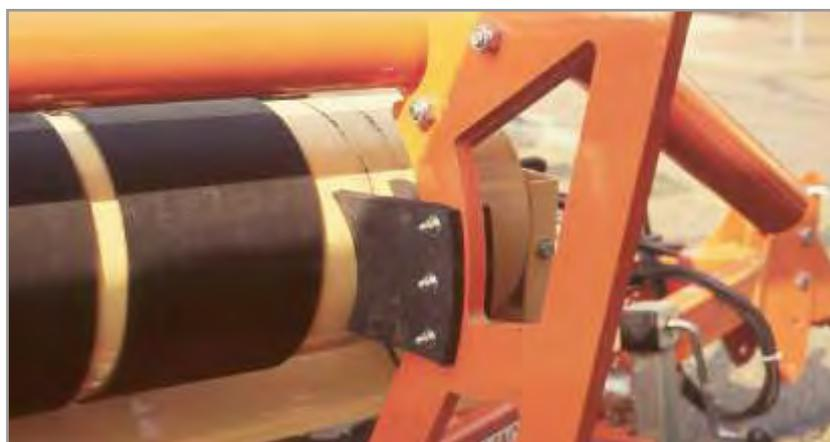
**Figura 5.21.** Tope/freno de goma que impide que se abran las correas.
