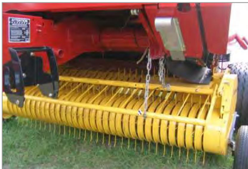
**Figura 4.75.** Recolector más ancho que la cámara de compactación.
