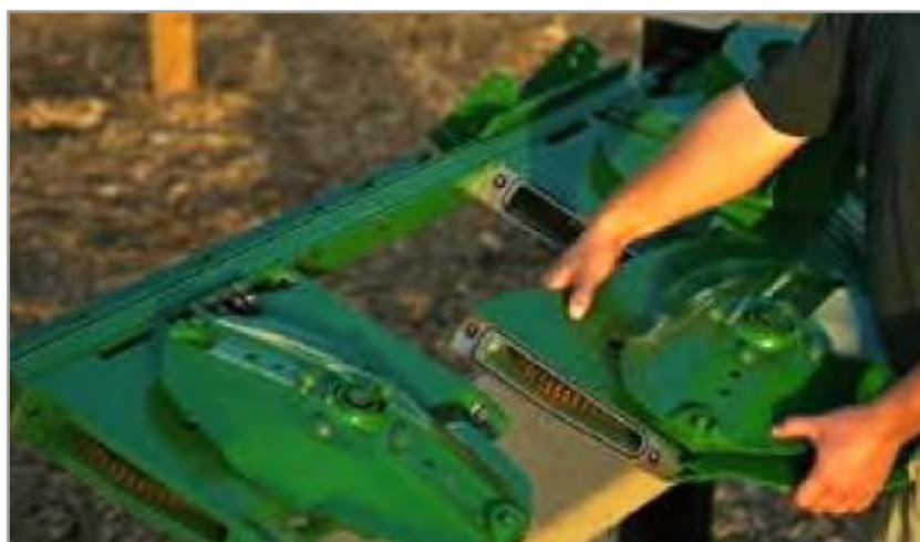
**Figura 4.28.** Plataforma de corte de secciones independientes.
