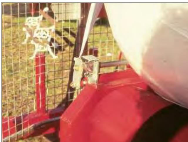
**Figura 5.23.** Detalle del cortador automático del film.
