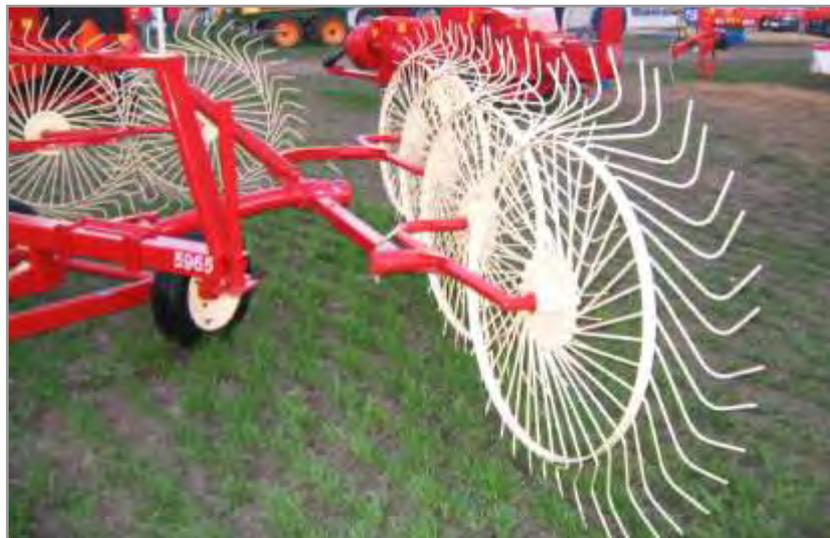
**Figura 4.49.** Rastrillo estelar (en “V”) con diseño de ruedas montadas sobre balancín.
