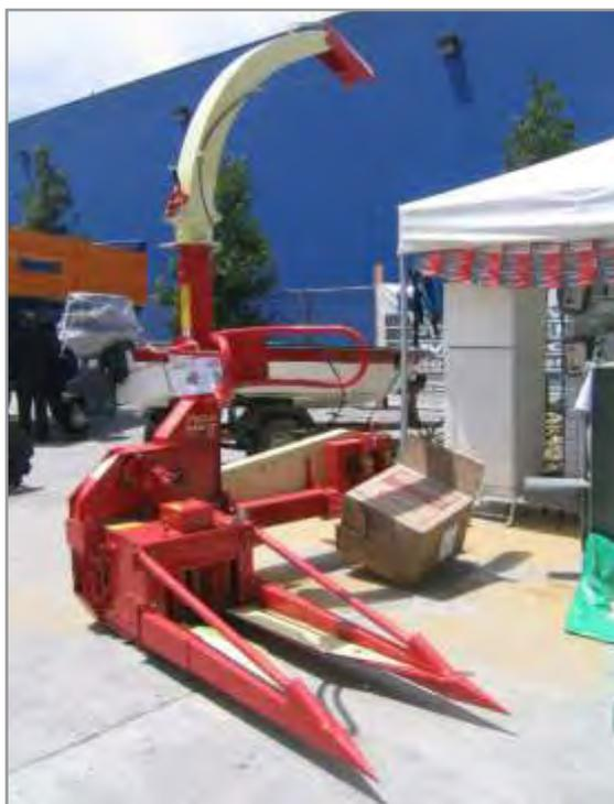
**Figura 6.16.** Picadora de un surco que no presenta sistema de corte en la punta del cabezal, con riesgo de ocasionar caída de plantas.
