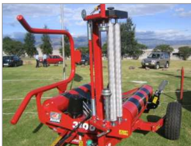
Figura 5.28. Portabobina, para film de 1 m de ancho.
