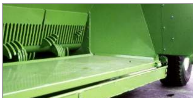
Figura 10.35. Sistema de doble fondo que facilita el vaciado del túnel, dentro de la bolsa.
