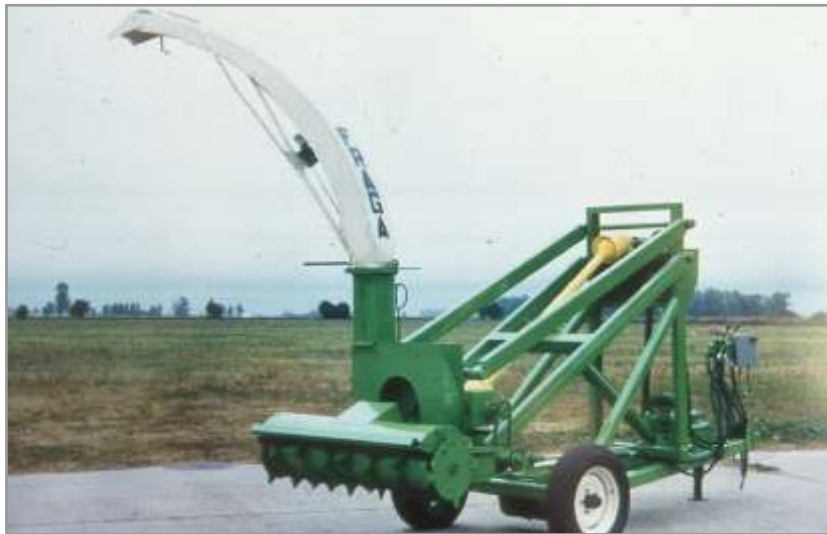
Figura 11.15. Fresa de extracción y soplado a un acoplado.
