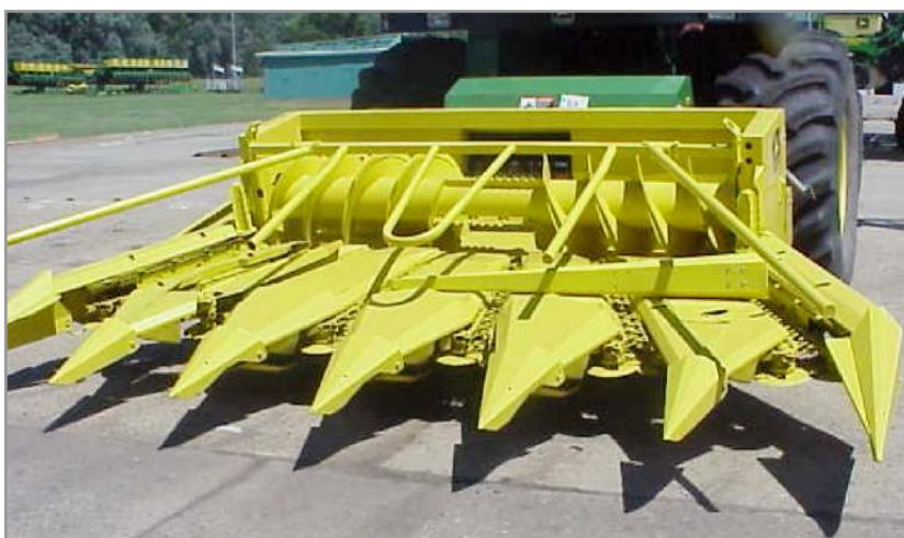
Figura 7.7. Sistema de cabezales de corte para cultivos en hileras.
