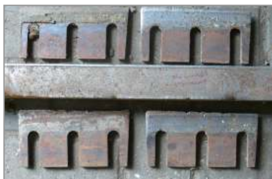
Figura 7.22. Muestras de desgaste de cuchillas y contra-cuchillas en suelos con piedras.
