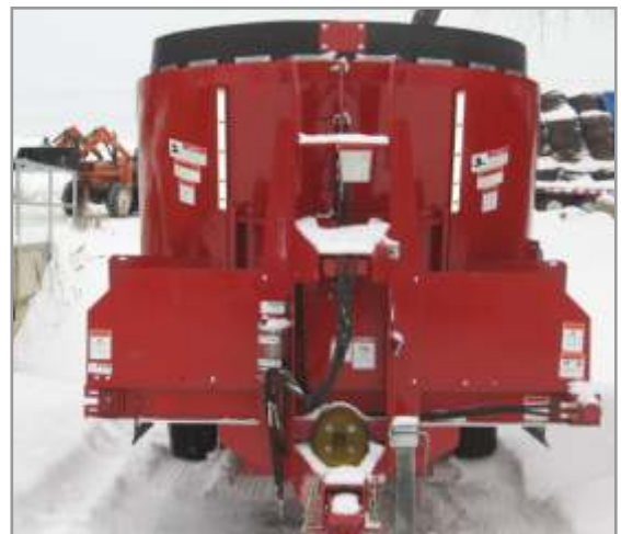
Figura 11.24. Sistema de descarga frontal con cinta de caucho que permite entregar el forraje a ambos lados del acoplado.
