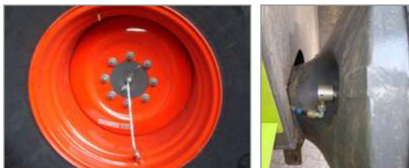
Figura 7.36. (Izq.): Neumático de presión regulable en CLAAS Jaguar 980, el cual disminuye su presión de inflado cuando esta trabajando y aumenta su libraje cuando la maquina se transporta. (Der.): palier agujereado para pasar aire, esta novedad parece marcar un nuevo paradigma sobre la transitabilidad de las máquinas sobre el suelo agrícola, donde la baja presión de inflado determina el nivel de huellas y compactación.
