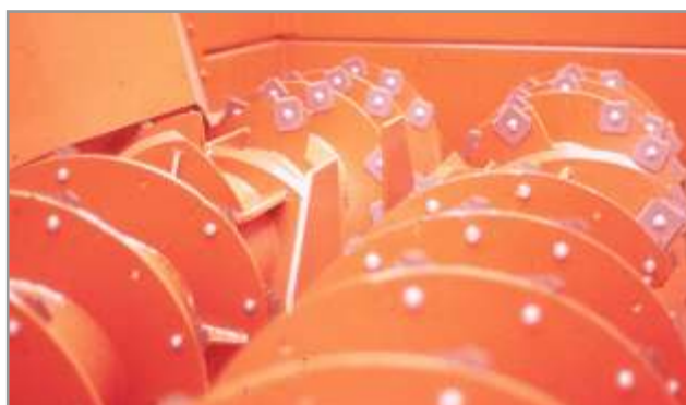
Figura 11.29. Dos sinfines horizontales con cuchillas periféricas.
