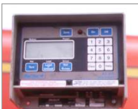
Figura 11.19. Las balanzas facilitan el control de carga y descarga mejorando el nivel de eficiencia en la alimentación.
