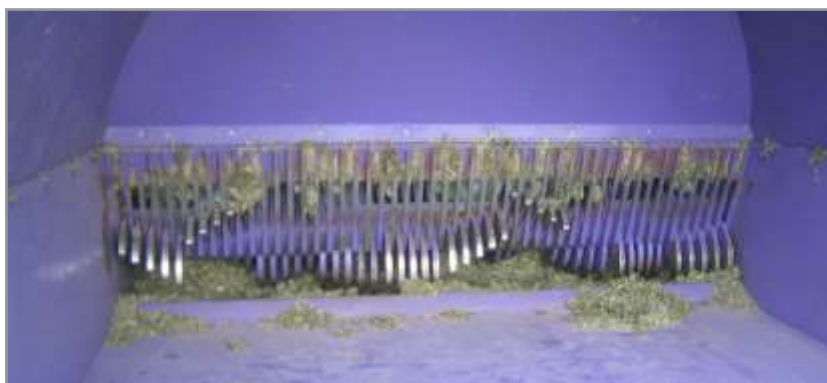
Figura 10.19. Máquina con el rotor del mismo ancho que el túnel de compactación.
