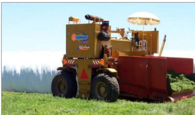
Figura 10.28. Máquina embolsadora con el puesto de comando ubicado en el lateral opuesto al motor.
