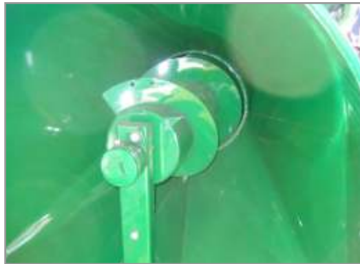
Figura 10.29. Sinfín de compactación dentro del túnel.
