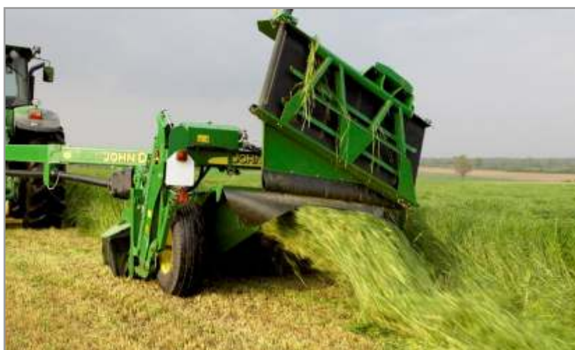
Figura 8.10. Sistema de agrupadores de andanas adosados a las cortadoras. En la pasada siguiente se baja la noria y juntan dos hileras sin necesidad de usar rastrillos, mejorando la higiene del forraje. En la fotografía el juntador se encuentra desactivado.
