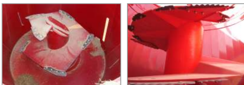
Figura 11.33. Vistas de los sinfines de mezclado y corte de fibra.
