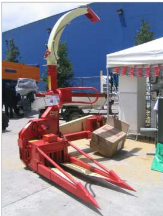
Figura 6.16. Picadora de un surco que no presenta sistema de corte en la punta del cabezal, con riesgo de ocasionar caída de plantas.
