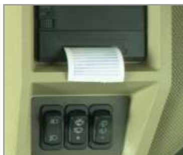
Figura 7.34. Sistema de impresión para entregar información al instante, del trabajo realizado.
