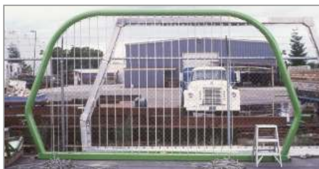
Figura 10.21. La red debe ser tejida primero en sentido vertical y por último en forma horizontal.
