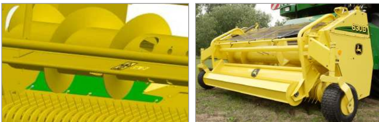
Figura 7.6. Esquema de cabezal de recolección de pasturas pre oreadas, con cilindro acompañador del ingreso del material levantado por los dientes de recolección y un sinfín de alimentación con dedos retráctiles en el centro.
