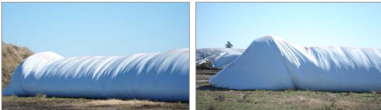
Figura 10.7. Ejemplo de confección defectuosa: zona de sobre-estiramiento en el inicio de la bolsa. Esto puede hacer peligrar la permanencia de la bolsa durante el período de almacenaje.
