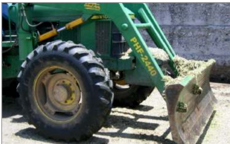
Figura 6.21. Si se pone un tope en los hidráulicos del sistema de desparramado, se facilita la operación del mismo evitando bajarlo a menos de 10 cm.
