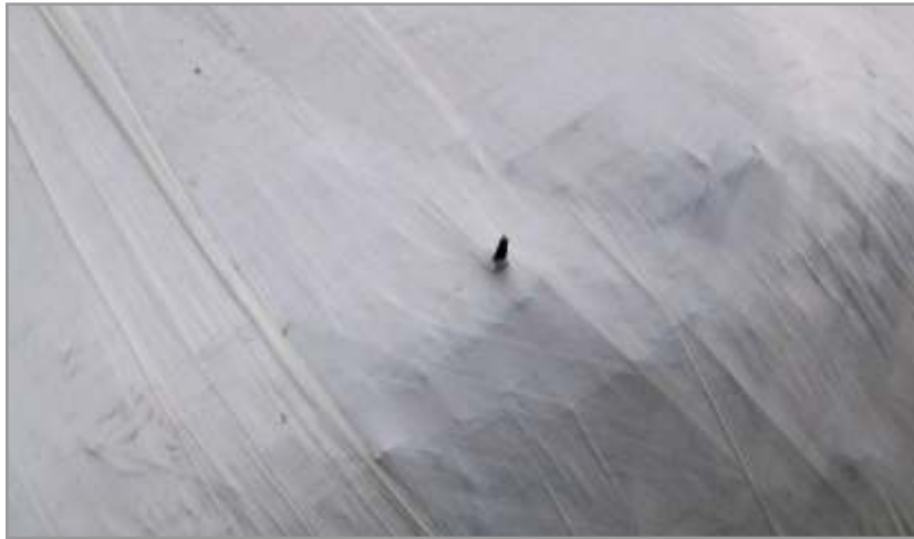
Figura 5.5. Se observa el perforado de la cobertura plástica, debido a un tallo.
