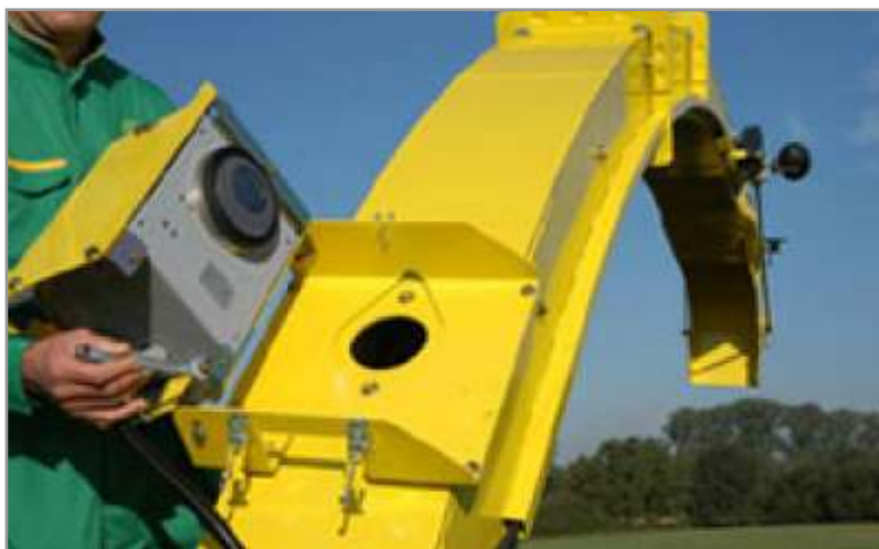
Figura 7.31. Sistema de medición de calidad de infrarrojo cercano (NIRS), montado en el sistema de descarga de la picadora.
