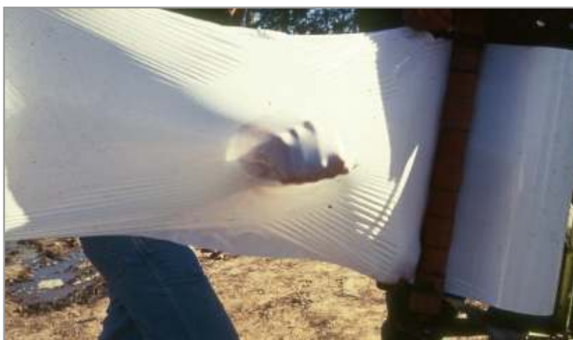
Figura 5.12. Prueba de calidad del film. Prueba del puño.
