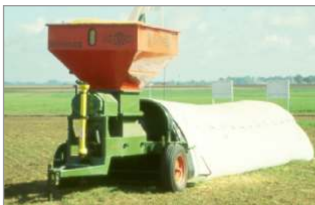
Figura 10.32. Embolsadoras de grano húmedo, con tolva de recepción y sistema de freno en las ruedas.
