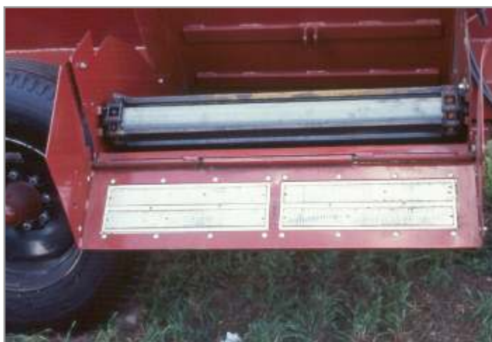
Figura I I.26. Trampas de metal para prevenir accidentes por la ingestión de cuerpos metálicos en la ración.
