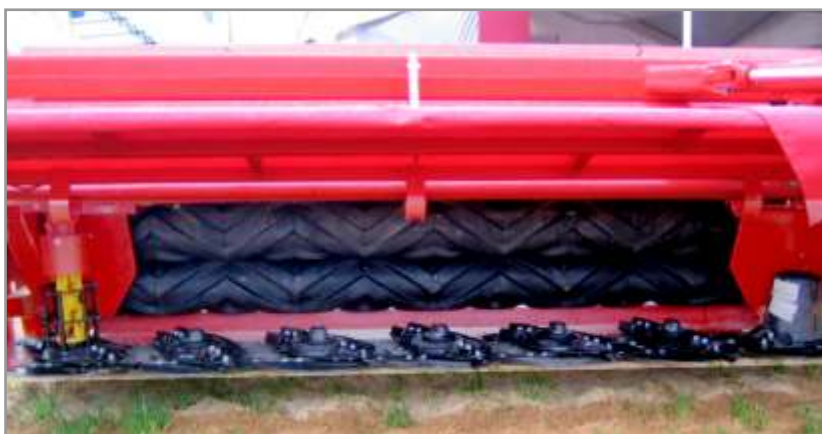
Figura 4.24. Cortadora acondicionadora de discos con cuchillas cortas.
