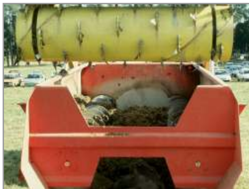
Figura 11.14. Acoplados mixer con fresa incorporada.
