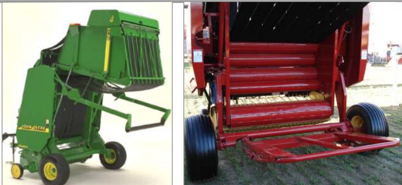
Figura 4.88. Pateador expulsor y rampa de descarga de los rollos.
