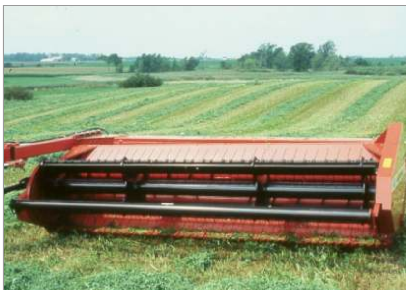
Figura 4.17. Máquina con sistema de corte alternativo, con reducida adopción en nuestro país.
