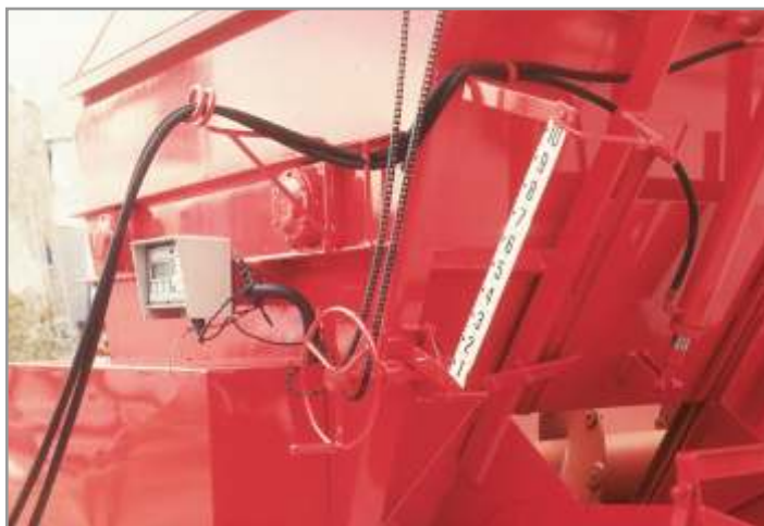
Figura I I.25. Regla indicadora de la apertura de la puerta de descarga.
