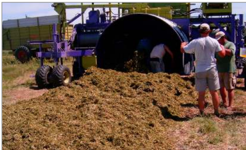
Figura 10.34. Vaciado del túnel de compactación.
