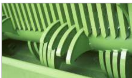
Figura 10.18. Detalle de los álabes del rotor con el peine de alimentación al túnel de compactación.
