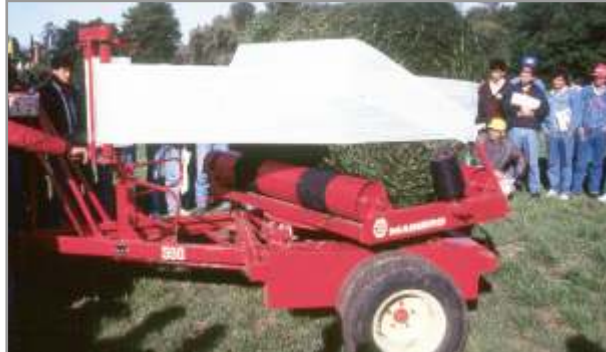
Figura 5.18. En la fotografía se puede observar la superposición al 50% de las capas del film.
