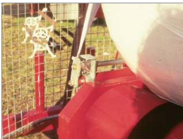
Figura 5.23. Detalle del cortador automático del film.
