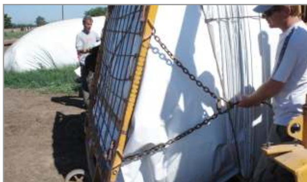
Figura 10.6. Inicio de la bolsa con la red inclinada para facilitar el cambio de las mismas.
