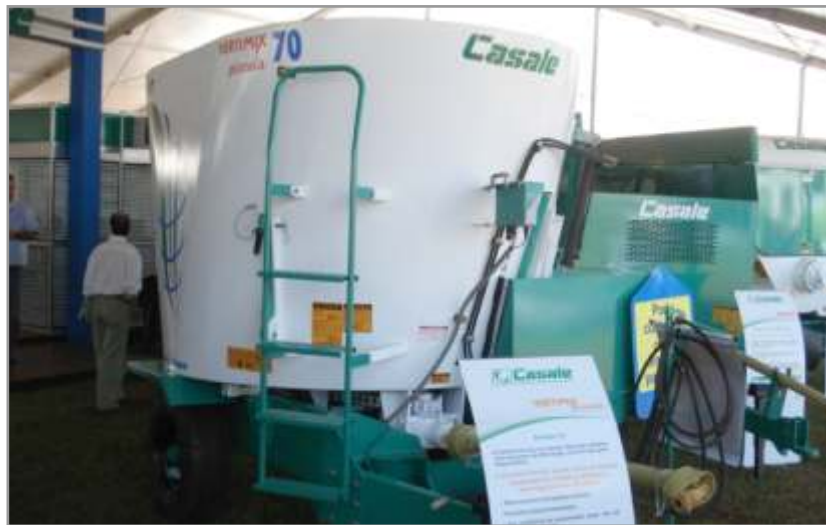
Figura 11.20. Mixer con sistema de transmisión de datos en tiempo real, sobre carga y descarga de alimentos.
