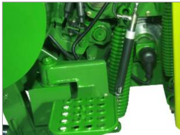
Figura 7.32. Ubicación de sensor de flujo de forraje.
