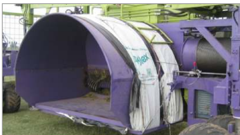
Figura 10.24. Máquina con dos bolsas montadas en el túnel de compactación.
