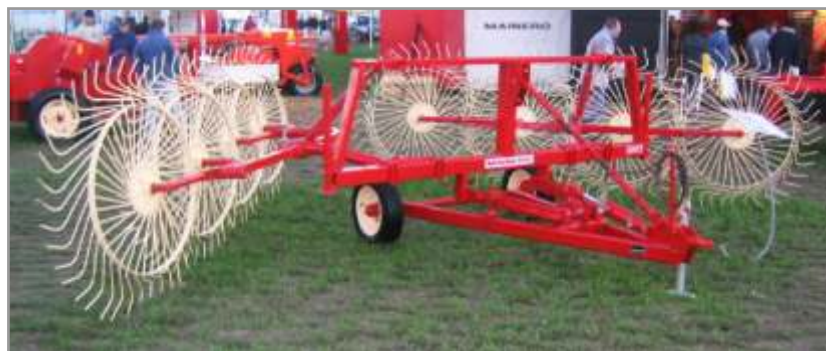
Figura 4.48. Rastrillo de arrastre con diseño de ruedas en “V”.
