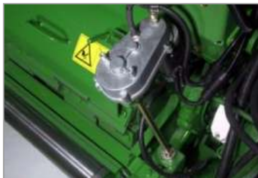
Figura 7.25. Mecanismo de ajuste de la contracuchilla.
