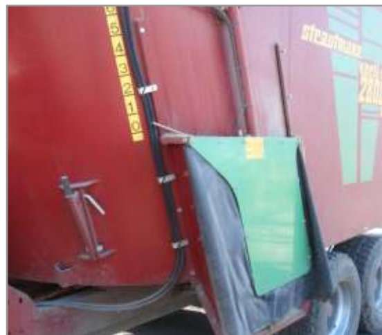
Figura I I.25. Regla indicadora de la apertura de la puerta de descarga.
