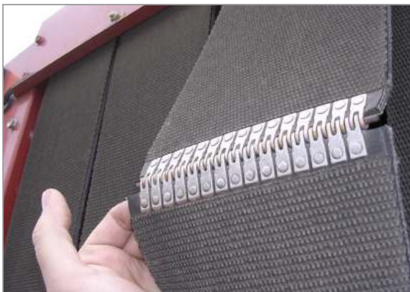
Figura 4.82. Unión de correa flexibles que aumentan la vida útil de las mismas.
