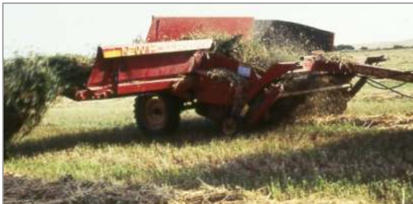
Figura 4.53. Invertidor de andana en pleno trabajo. Si bien para la confección de heno puede resultar de un costo excesivo, para el trabajo con silaje de pasturas en zonas de campo con piedra, reducen mucho el riesgo de rotura de las picadoras.
