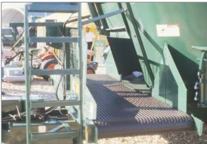
Figura 11.24. Sistema de descarga frontal con cinta de caucho que permite entregar el forraje a ambos lados del acoplado.
