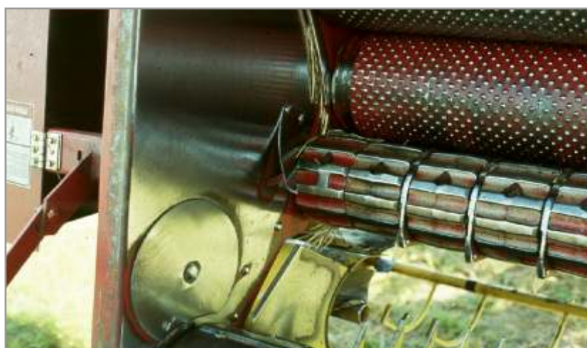
Figura 5.11. En la fotografía se muestra el rollo que porta las cuchillas retráctiles.
