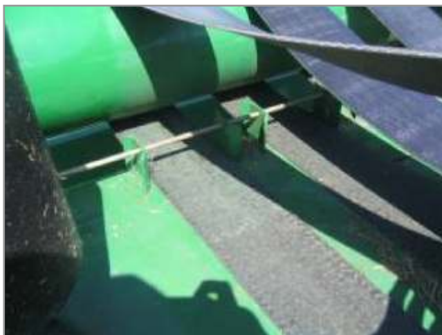
Figura 5.22. Guía de las correas para evitar corrimiento o superposición de las mismas.
