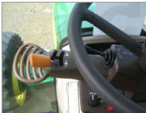
Figura 11.12. El reversor de marchas alivia la fatiga en la operación y disminuye el desgaste del tractor.
