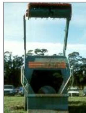
Figura 11.14. Acoplados mixer con fresa incorporada.
