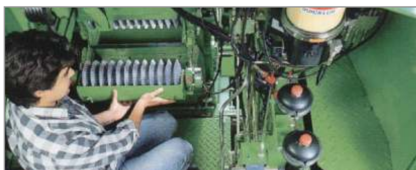
Figura 7.29. Intercambiando los rodillos partidores.
