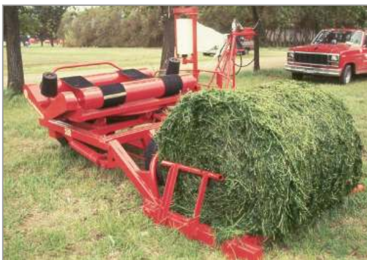
Figura 5.17. Se puede observar la regulación o espaldera del rollo para centrarlo en la mesa.
