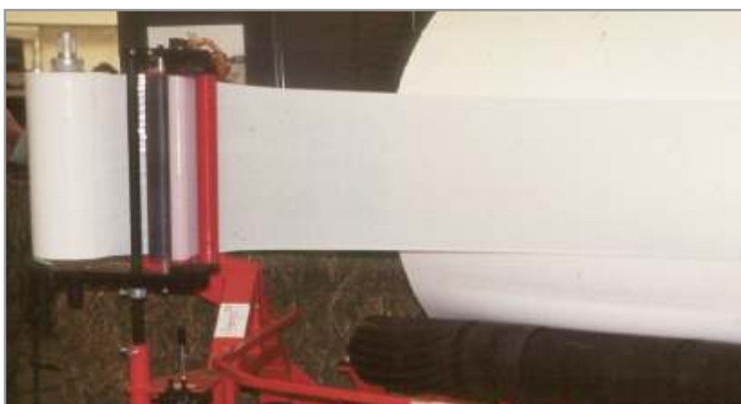
Figura 5.26. Al momento de la salida del film se observa que el mismo se achica un 15% en su ancho.
