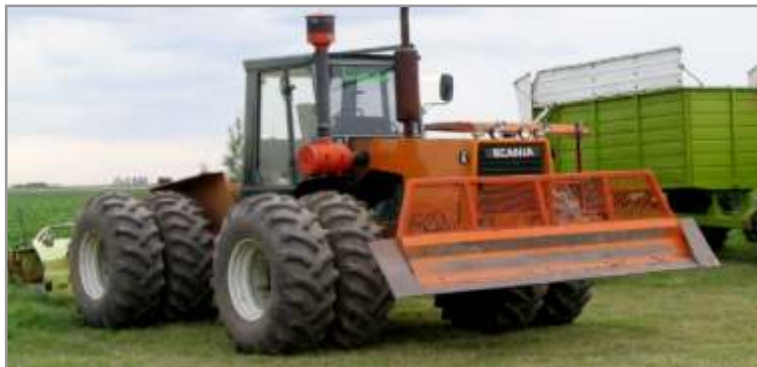
Figura 6.20. Tractor muy utilizado para la compactación de los silos aéreos.
