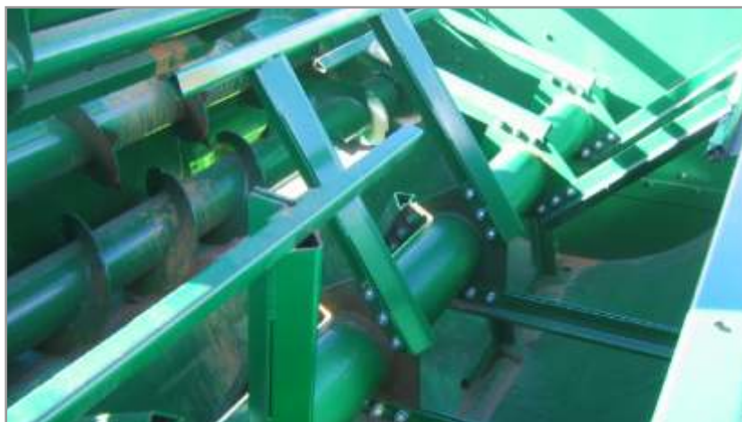
Figura 11.32. Interior de mixer de mezcla vertical con paletas divididas, para repartir el esfuerzo y sinfines para el traslado longitudinal del forraje.
