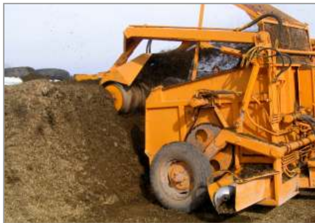
Figura 11.13. Fresa adosada a una batea para su suministro.
