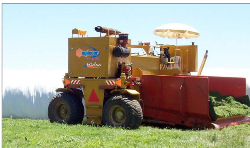
Figura 10.2. Confección de silos bolsa, sobre un manto de cobertura verde para preservar la base de la bolsa.
