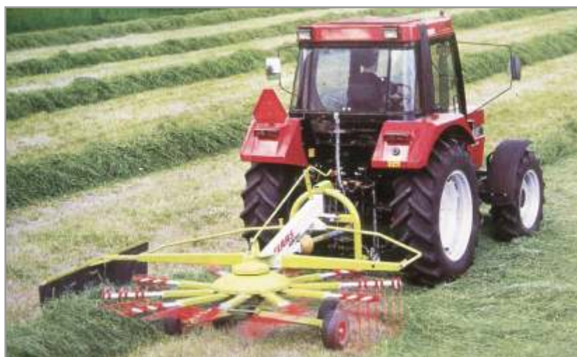
Figura 4.51. Rastrillo giroscópico con una correcta regulación en la formación de las hileras.
