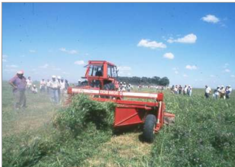
Figura 4.33. Regulación posterior de los deflectores formadores de andanas.
