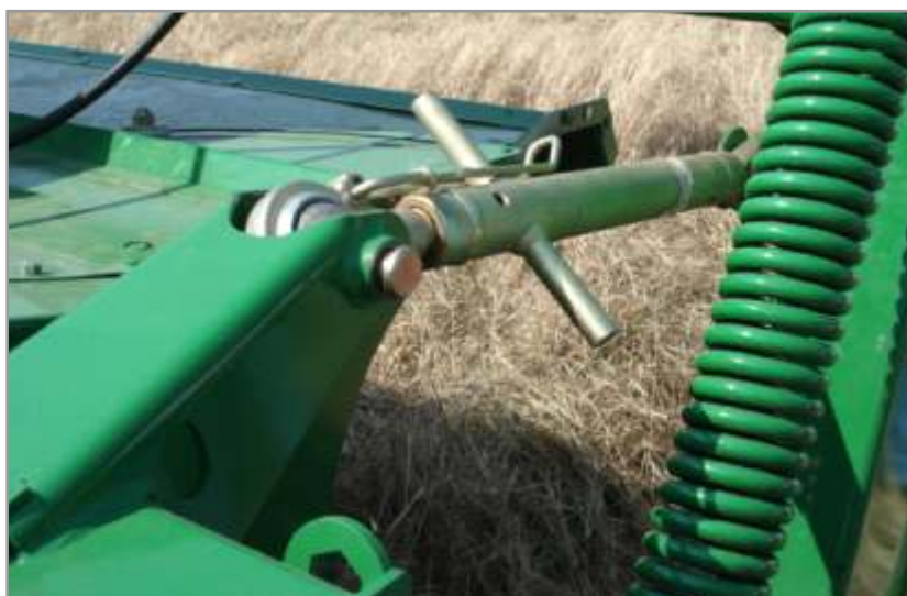
Figura 4.31. Dispositivo de doble rosca para regular la inclinación del ángulo de corte.
