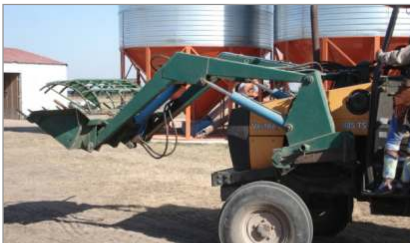
Figura 11.3. La gran distancia del balde al eje del tractor aumenta el brazo de palanca e incrementa la fatiga del tren delantero.
