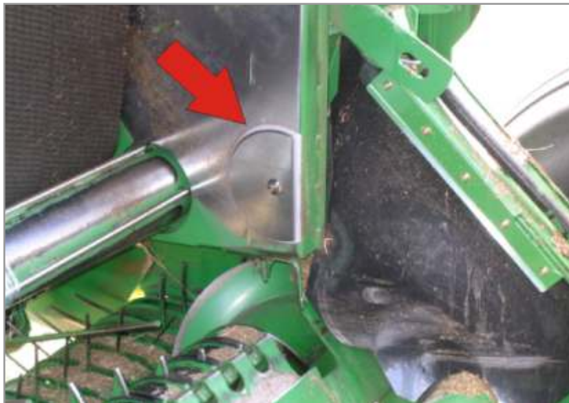
Figura 4.60. Sensor de humedad incorporado en la cámara de compactación de la rotoenfardadora.
