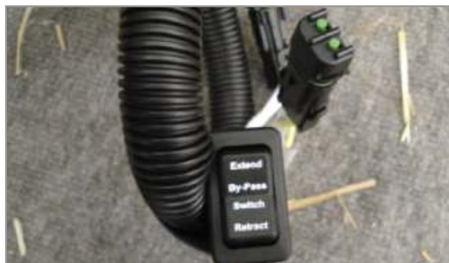
Figura 4.86. Ficha de By Pass o puente hacia el sistema eléctrico para trabajar sin necesidad del atador.
