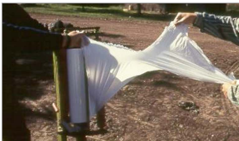
Figura 5.13. Prueba de desgarramiento para verificar la calidad del film.
