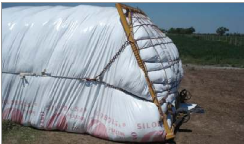
Figura 10.22. Se observa la diferencia de largo de la rienda inferior que sujeta la red, para facilitar su posición al inicio de la bolsa, y su movimiento cuando se finaliza la confección de la misma.
