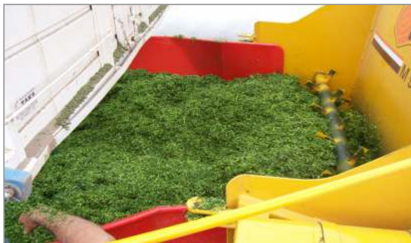
Figura 8.15. El rotor superior ayuda a ir "enrazando" el material en la bandeja de descarga.
