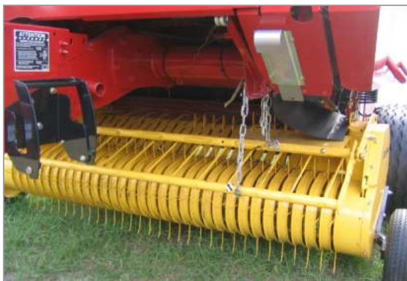
Figura 4.75. Recolector más ancho que la cámara de compactación.
