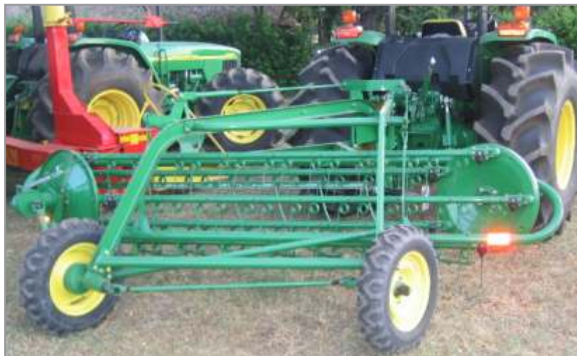
Figura 4.52. Rastrillo de barras paralelas y molinetes oblicuos, con accionamiento mediante cardan a la rueda del mismo.
