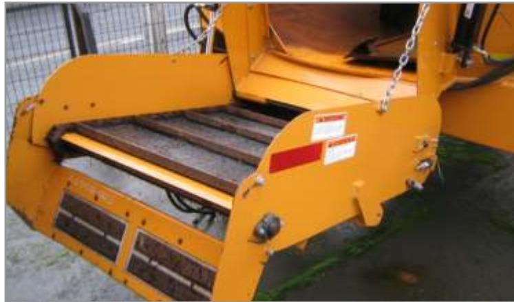
Figura 11.23. Sistema de descarga de noria, con barras y cadenas.
