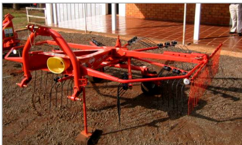
Figura 8.11. Los rastrillos giroscópicos representan una herramienta muy útil al momento de juntar hileras en la confección de silos de pasturas.
