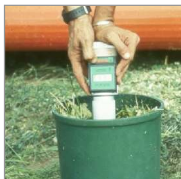
Figura 8.7. Los humidímetros con sensores para medir en baldes plásticos, son los más apropiados para la estimación de materia seca de pasturas para silaje.
