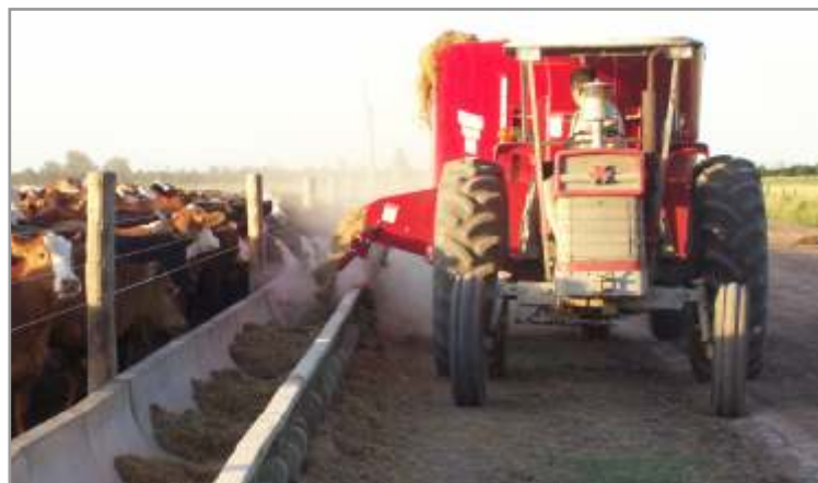
Figura 11.21. Cuando los lugares de descarga tienen altura constante no ofrecen mayores dificultades.
