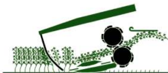
Figura 4.40. Esquema de trabajo de un sistema de acondicionado mediante rodillos.
