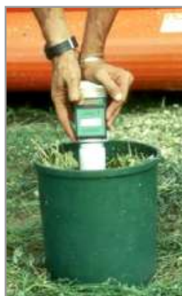
Figura 5.8. Medición del porcentaje de humedad de forraje húmedo, con humidímetro adecuado y en balde plástico.
