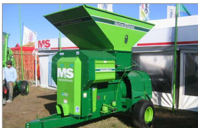
Figura 10.32. Embolsadoras de grano húmedo, con tolva de recepción y sistema de freno en las ruedas.
