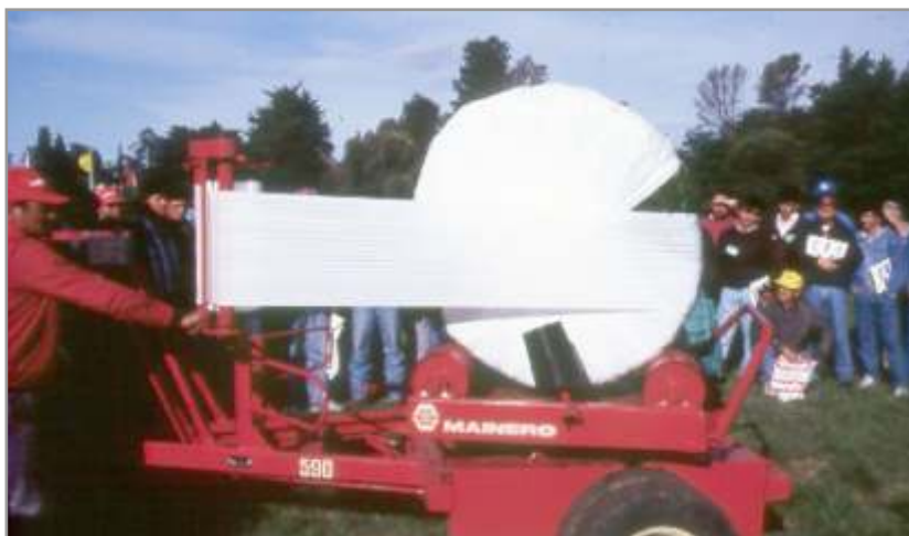
Figura 5.7. En el empaquetado del rollo es importante considerar que el viento debería estar en la misma dirección en que se observa la fotografía, para permitir el correcto pegado de las sucesivas capas de film
