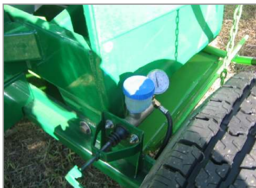
Figura 10.31. Regulación del freno hidráulico en las ruedas.
