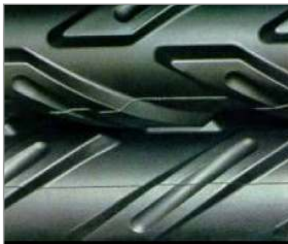
Figura 4.42. Detalle del diseño de los tacos de un rodillo acondicionador.
