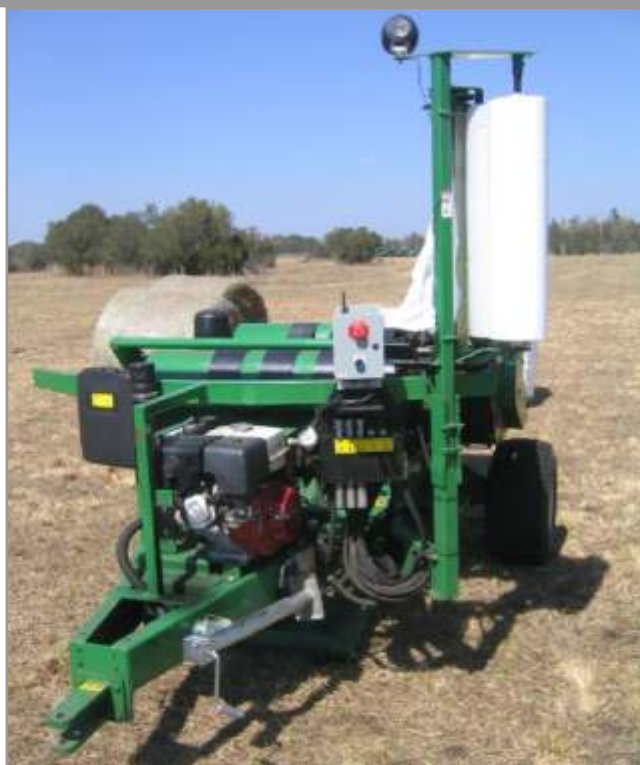
Figura 5.34. Empaquetadora individual con accionamiento a distancia y motor incorporado.
