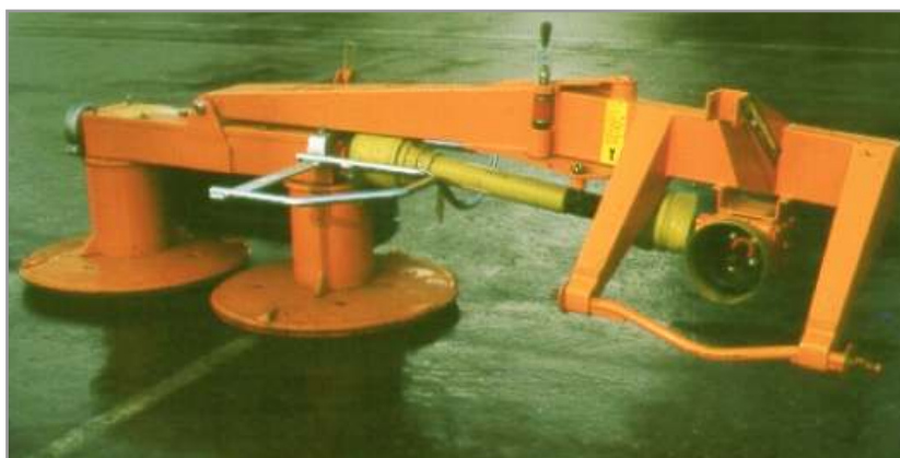
Figura 4.23. Cortadora de tambores con mando superior.
