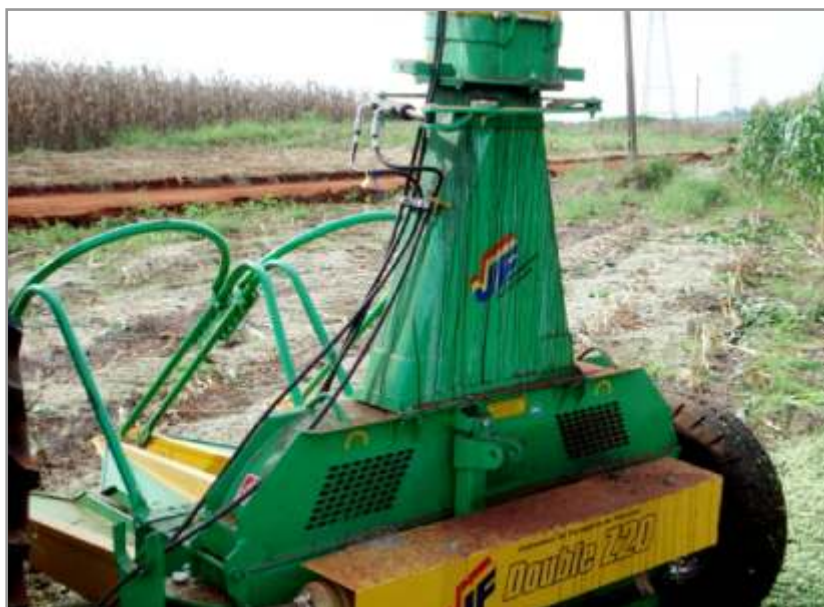
Figura 6.12. Se observa el "chorreado de jugos" sobre la picadora que trabaja en el picado de un cultivo de maíz temprano.
